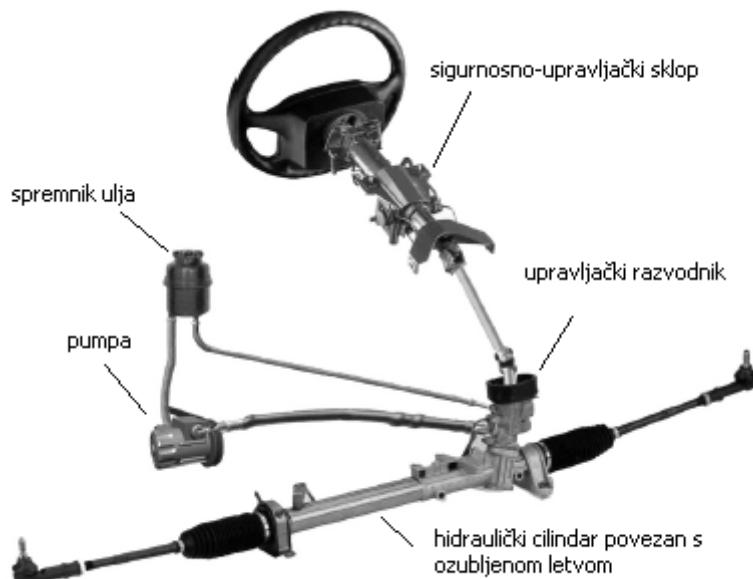
Slika 1. Prikaz hidrauličkog potpomognutog upravljanja i njegovi dijelovi
