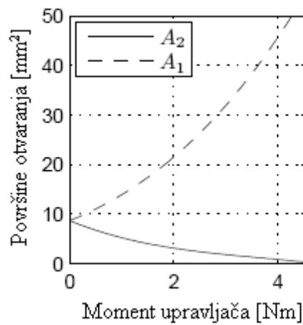
Slika 17. Površine otvaranja kao funkcije primjenjenom momentu upravljača.
