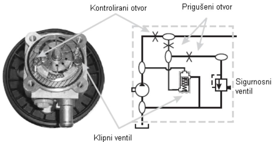
Slika 8. Pumpa uključujući kompenzator protoka.
