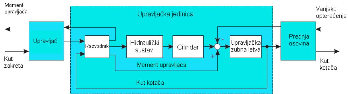
Slika 3. Upravljački sistem je dio zatvorene petlje vozila.
