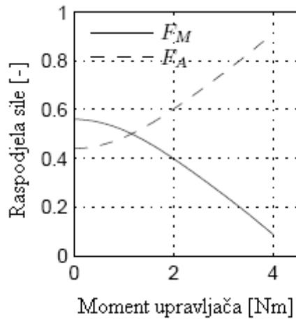
Slika 11. Raspodjela sile između ručne i pomoćne sile  $F_M$  i  $F_A$ , oviseći o primjenjenom momentu upravljača.
