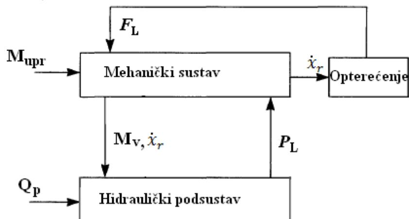
Slika 9. Blok dijagram hidrauličkog upravljačkog sustava
