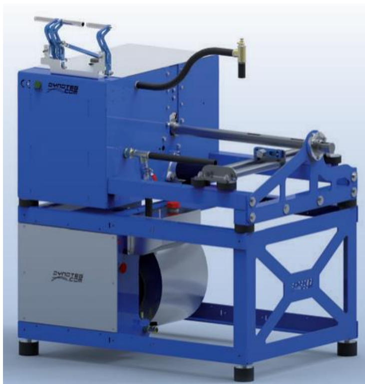
Slika 10. Inercijska kočnica Dynoteg-KED 1 [8]
