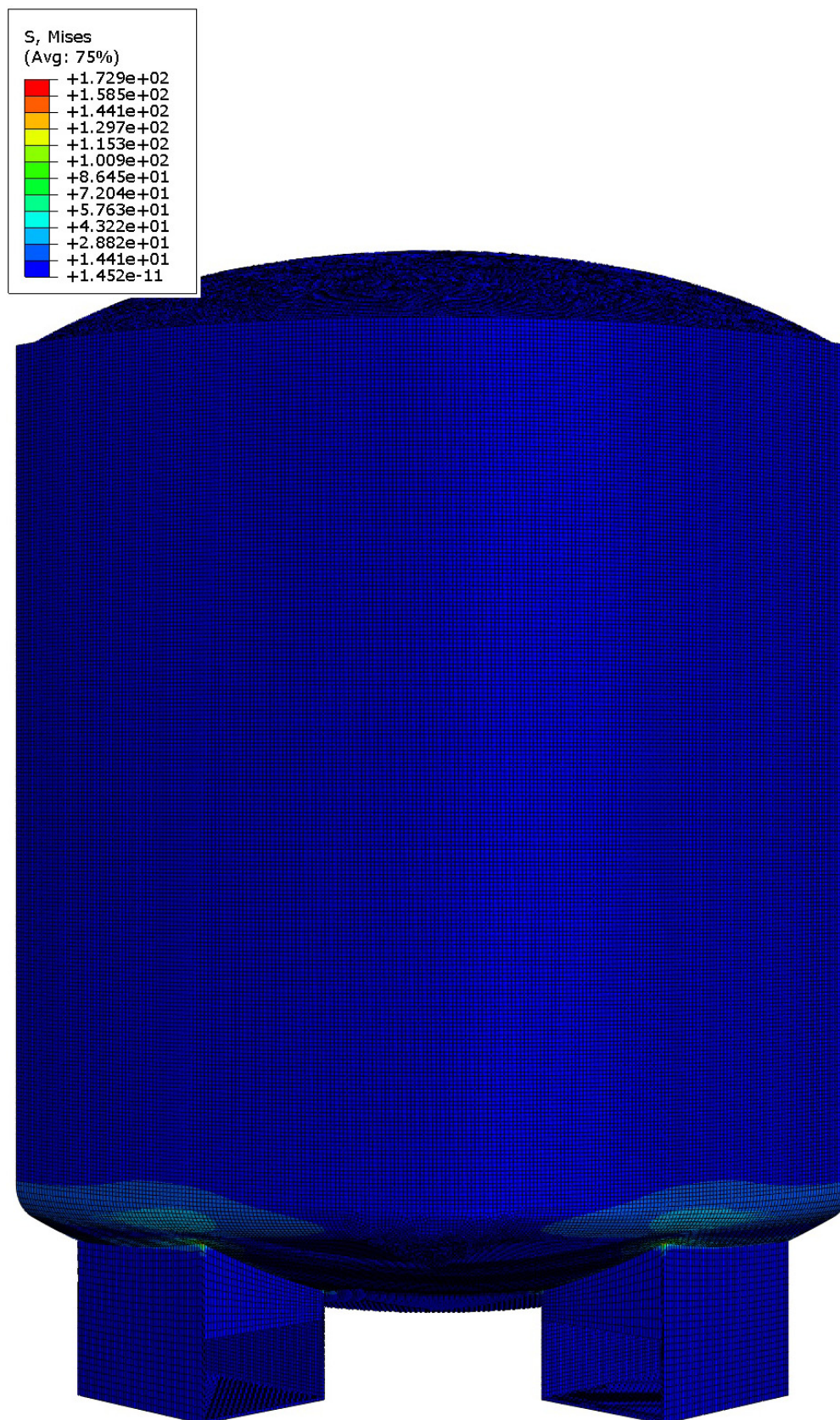
Slika 49. Naprežanje spremnika prema von Misesu
