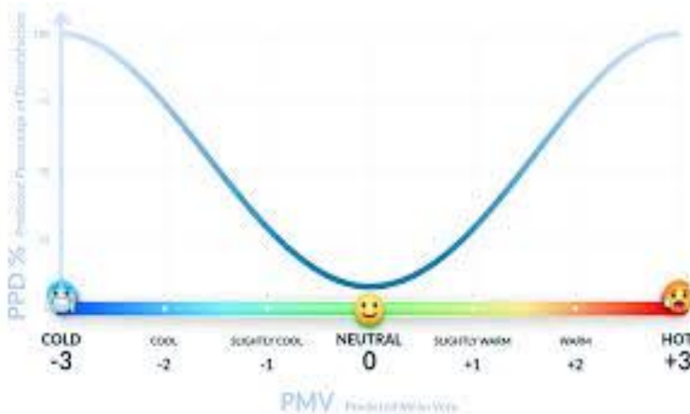
Slika 1 Prikaz predvidljivog postotka nezadovoljnih (PPD) u funkciji predvidljivog prosječnog vrednovanja (PMV)
