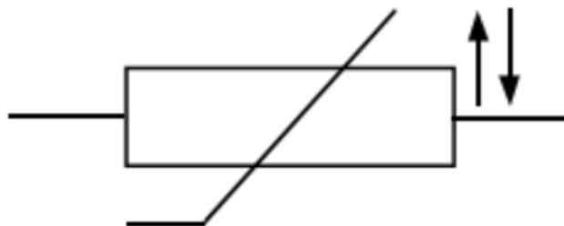
Slika 2.3 Simbol NTC otpornika
