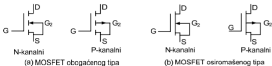
Slika 2.6 Vrste MOSFET tranzistora
