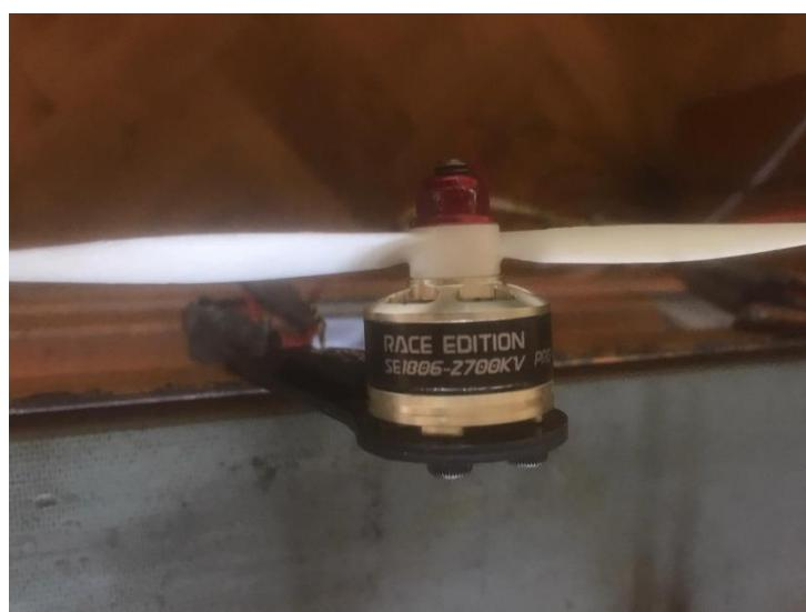
Slika 4.5 DYS SE1806KV 2700kv PRO
