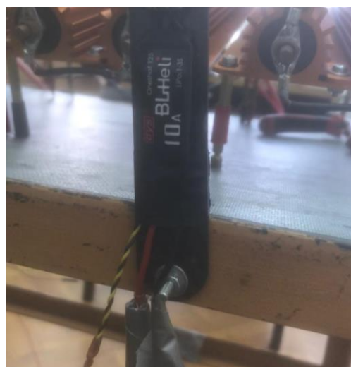
Slika 4.4 ESC korišten na modelu završnog rada, BLHeli oneshot125 10A [17]
