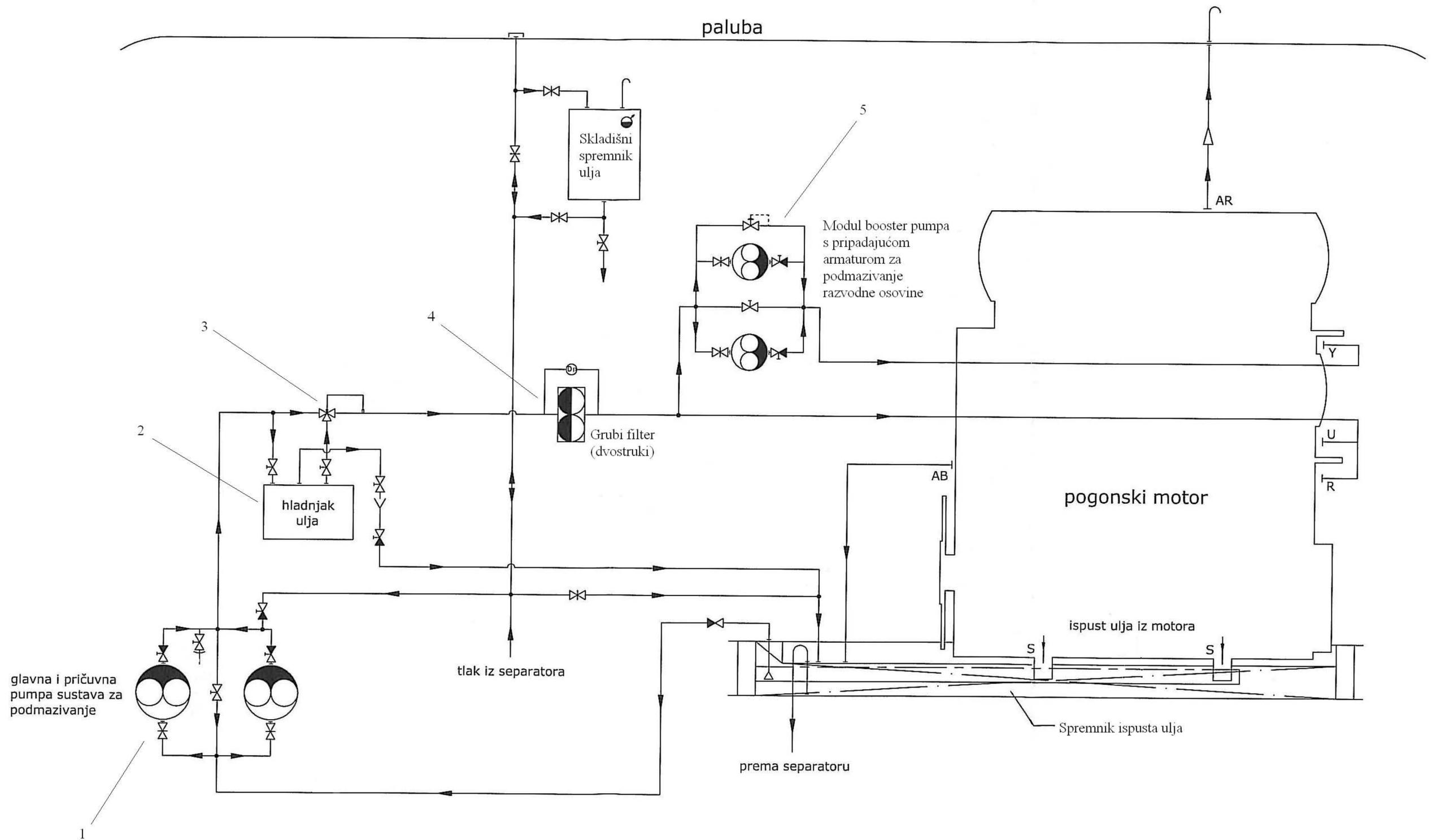
Slika 7. Sustav za podmazivanje motora MAN B&W S60MC [20]
