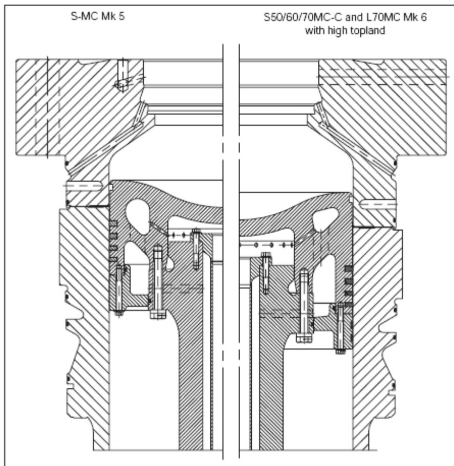
Slika 11. Izmjene oblika cilindara MAN B&W-ovih motora [25]
