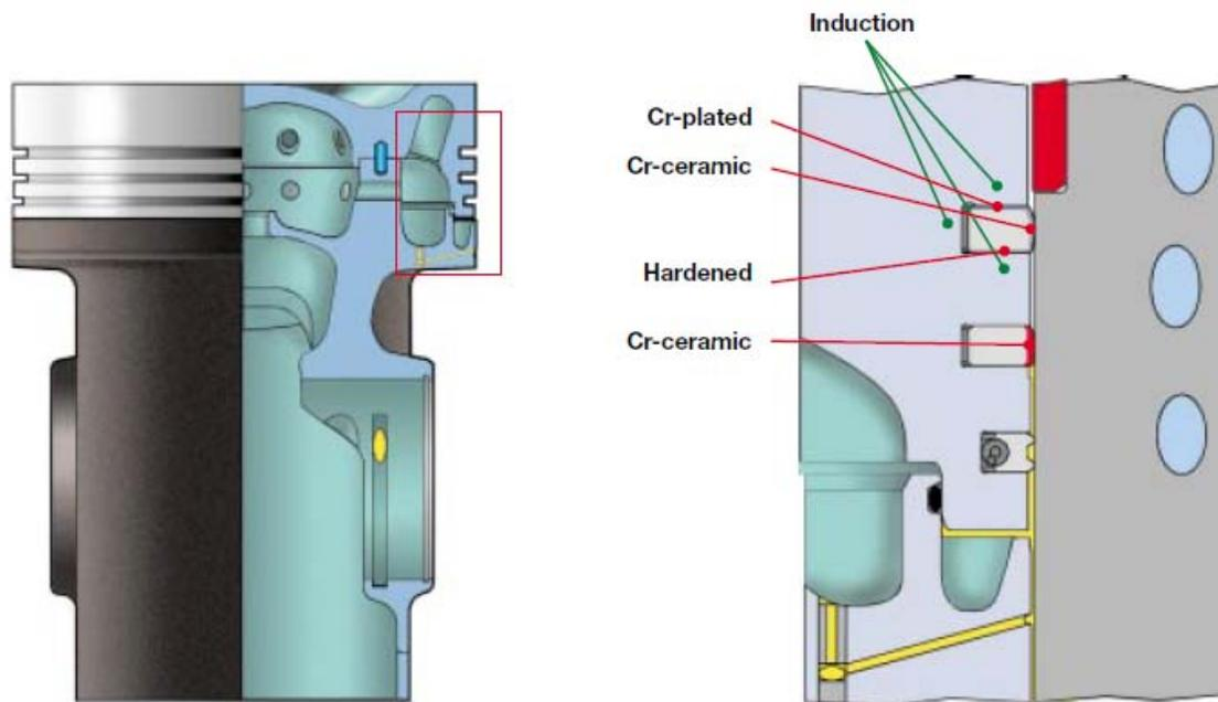
Slika 20. Poprečni presjek klipa Wärtsilä-e 64 [19]
