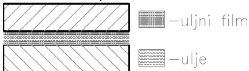
Slika 4. Hidrodinamičko podmazivanje
