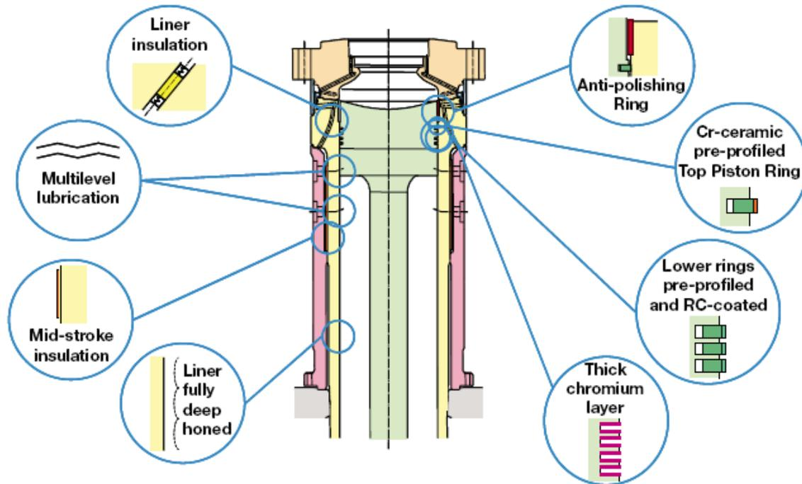
Slika 15. Inovacije na motoru Sulzer RTA-C [28]
