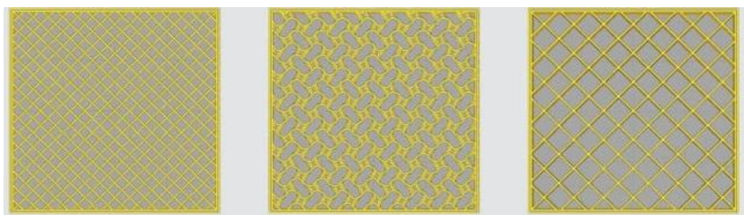
Slika 28 Uzorci tiskanja, lijevo linije, u sredini „gyroid“ i desno mreža[19]
