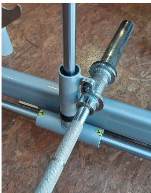
Slika 6.8. Sustav vodilica 3D Smith mašine
