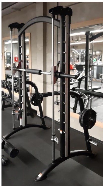
Slika 6.1. Smith mašina s vertikalnom putanjom
