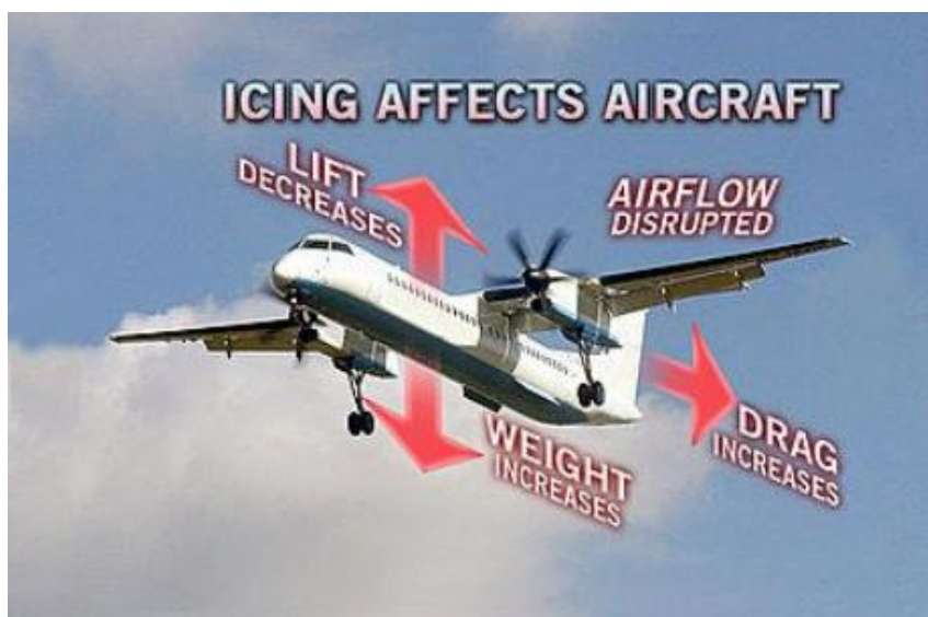
Slika 5. Utjecaj stvorenog leda na zrakoplov [3]
