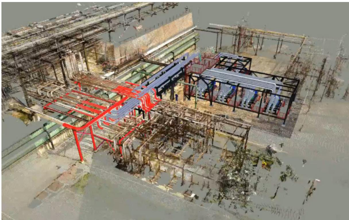
Slika 22. Dio industrijske građevine nakon modeliranja postojećeg stanja sa prikazom spoja novo projektiranih instalacija – označeno crvenom bojom
