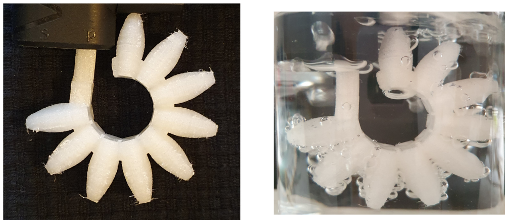
Slika 4.4: Prototip II, Debljina Mjehura povećana na 1.6 mm. Slika desno pokazuje propuštanje zraka
