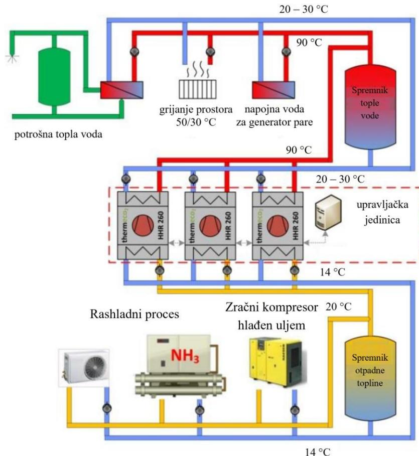
Slika 21. Ogrjevni proces s tri visokotemperaturne dizalice topline [22]
