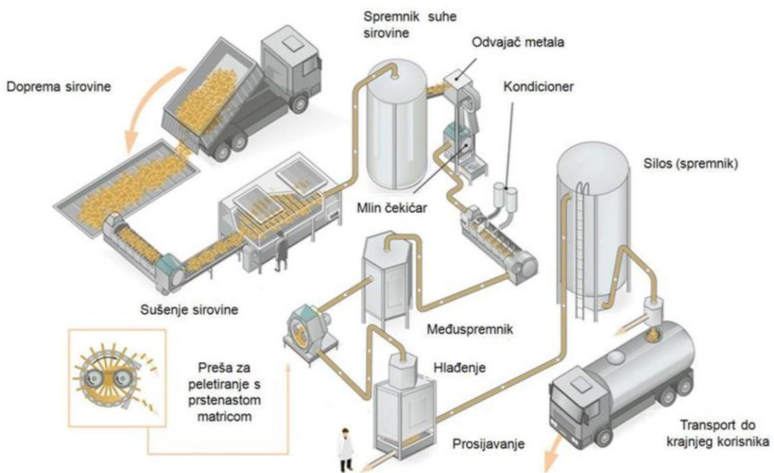
**Slika 23. Tehnološki postupak proizvodnje drvnih peleta [26]**
