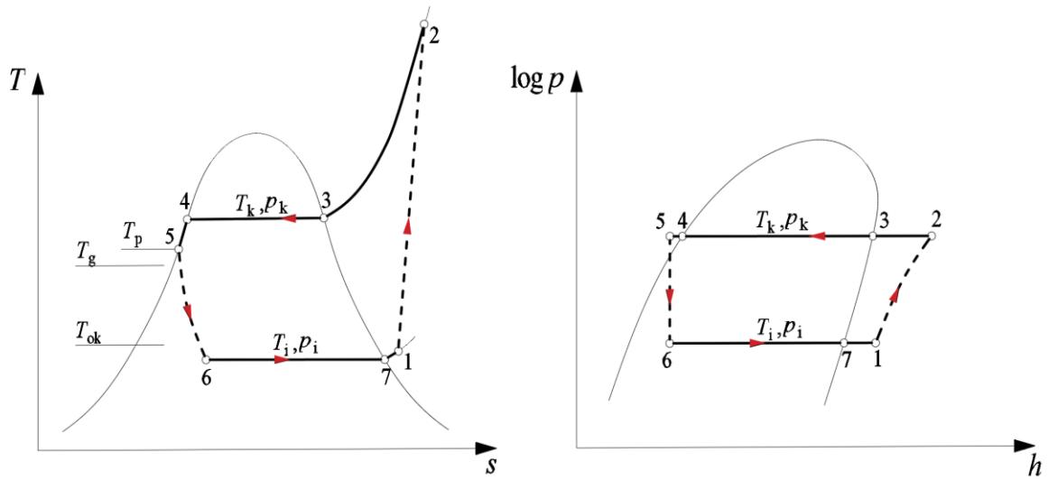
Slika 4. Dijagrami ogrjevnog procesa s pregrijavanjem pare i pothlađivanjem kapljevine
