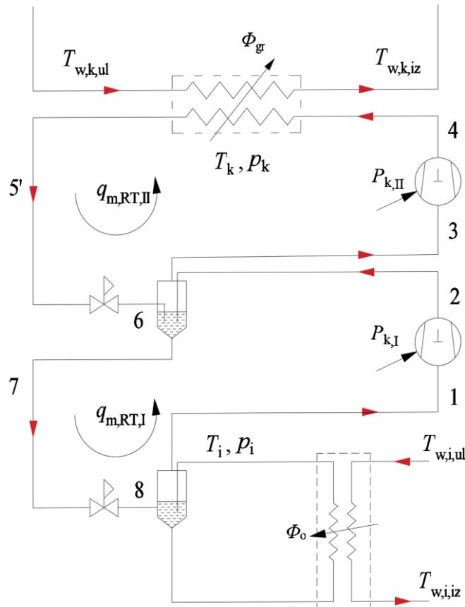
Slika 25. Shematski prikaz procesa s dvostupanjskom kompresijom
