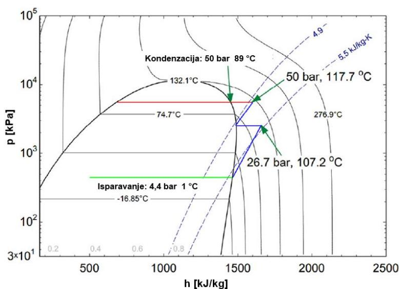
**Slika 13. Primjer procesa s amonijakom kao radnom tvari uz specifične radne točke [17]**
