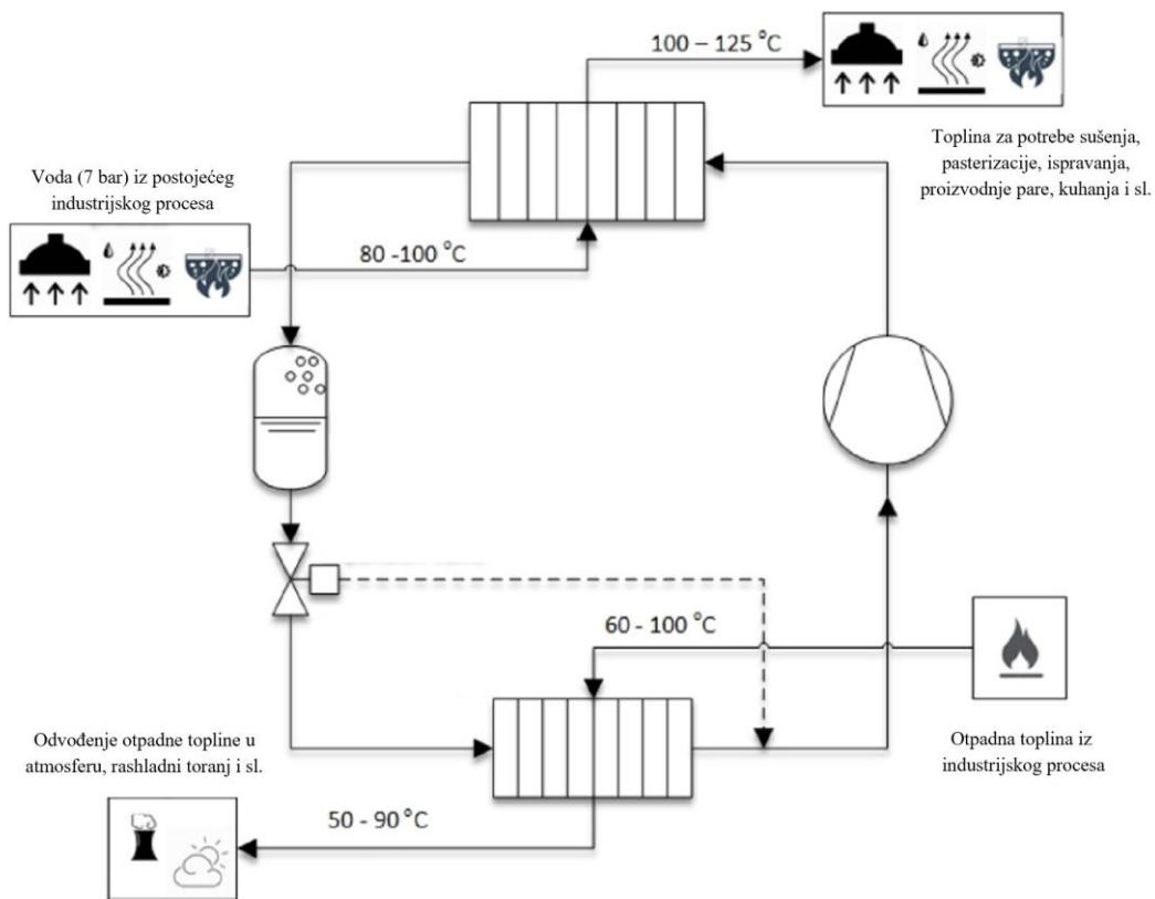
**Slika 11. Pojednostavljena shema procesa s visokotemperaturnom dizalicom topline [12]**
