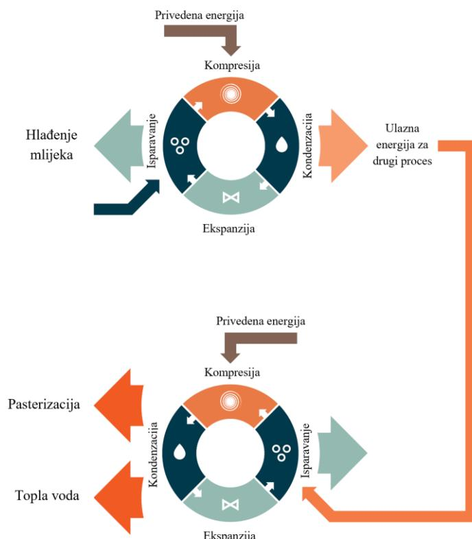
**Slika 19. Shematski prikaz korištenja otpadne topline pomoću visokotemperaturne dizalice topline u industriji [3]**
