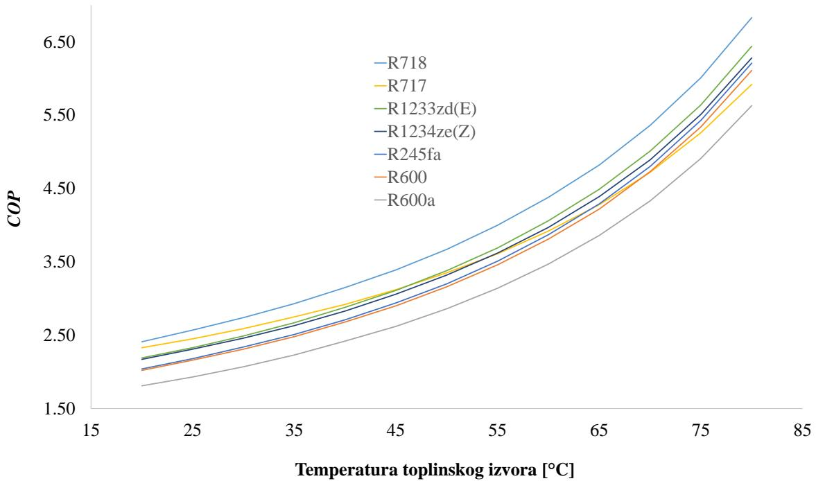
**Slika 27. Ostvarivi faktori grijanja za određene radne tvari u ovisnosti o temperaturi toplinskog izvora pri procesu s jednostupanjskom kompresijom s međuzmjenjivačem i temperaturi kondenzacije  $T_k = 113 \text{ } ^\circ\text{C}$**
