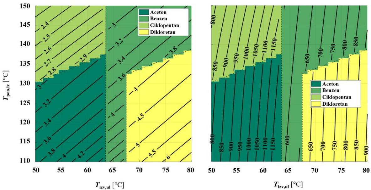
**Slika 10. Najučinkovitije radne tvari iz priloga B s pripadajućim COP (lijevo) i  $q_{\text{kond},v}$  vrijednostima (desno) [15]**
