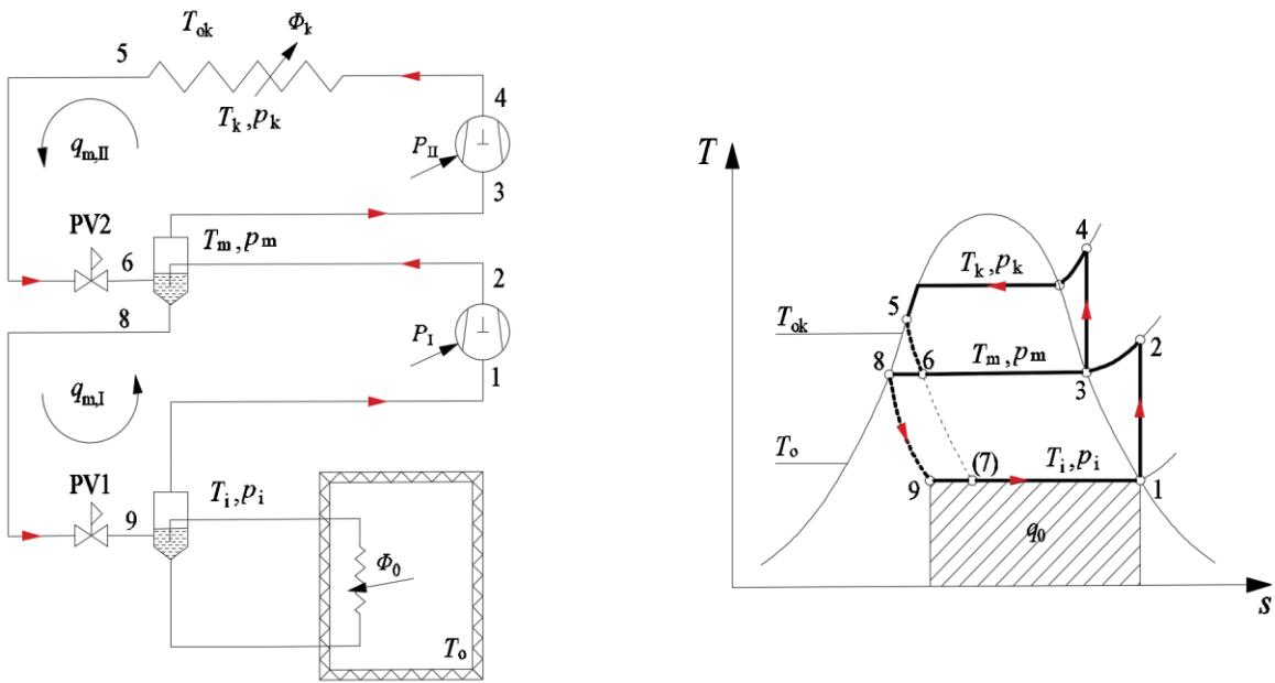
**Slika 7.** Rashladni uređaj s dvostupanjskom kompresijom, dvostupanjskim prigušivanjem i međuhladnjakom te pripadajući  $T$ - $s$  dijagram proresa (prema [10])
