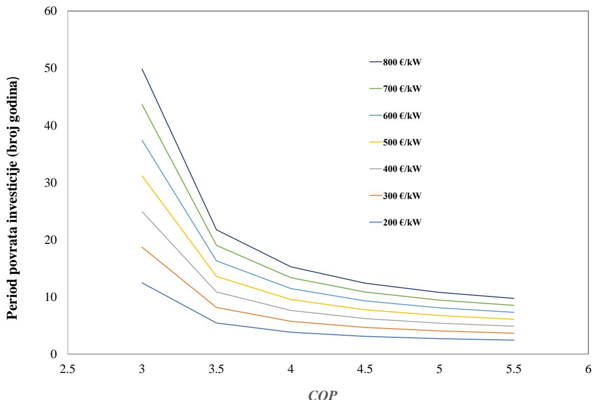
**Slika 29. Ovisnost duljine povrata investicije o ostvarenom faktoru grijanja s radnom tvari R1234ze(Z) uz sustav s dvostupanjskom kompresijom i cijeni investicije u odnosu na kotač na prirodn plin**
