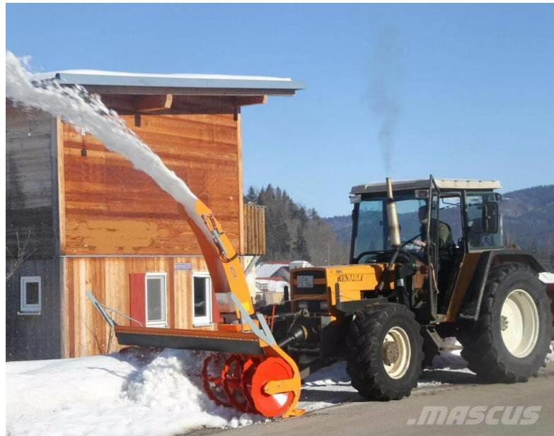
**Slika 8. Traktorski priključak za čišćenje snijega**
