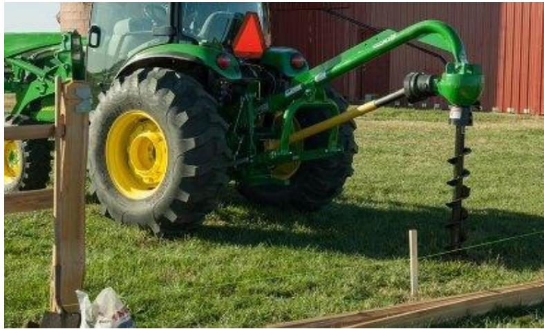
Slika 17. Traktorski priključak spojen na izlazno vratilo pomoću kardana
