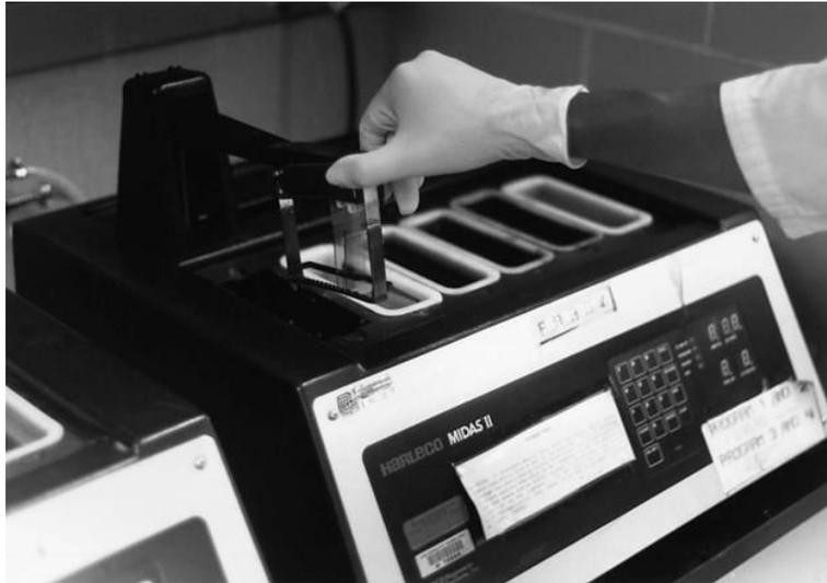
**Slika 17. Uređaj za izradu razmaza Midas II [7]**
