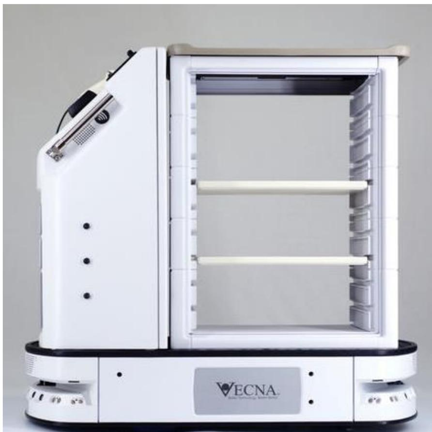
Slika 2. Mobilni laboratorijski robot QC Bot [22]
