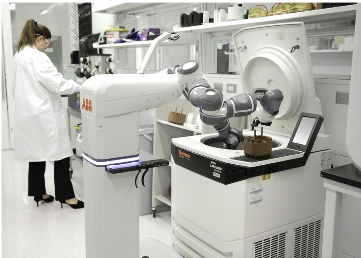
**Slika 8. Robot ABB Yumi za asistenciju u laboratorijima [9]**
