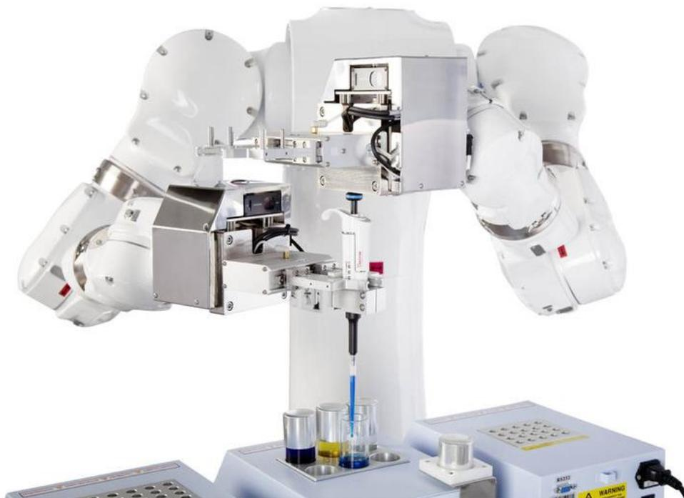
**Slika 9. Robot za pipetiranje Motoman CSDA10F tvrtke Yaskawa [10]**
