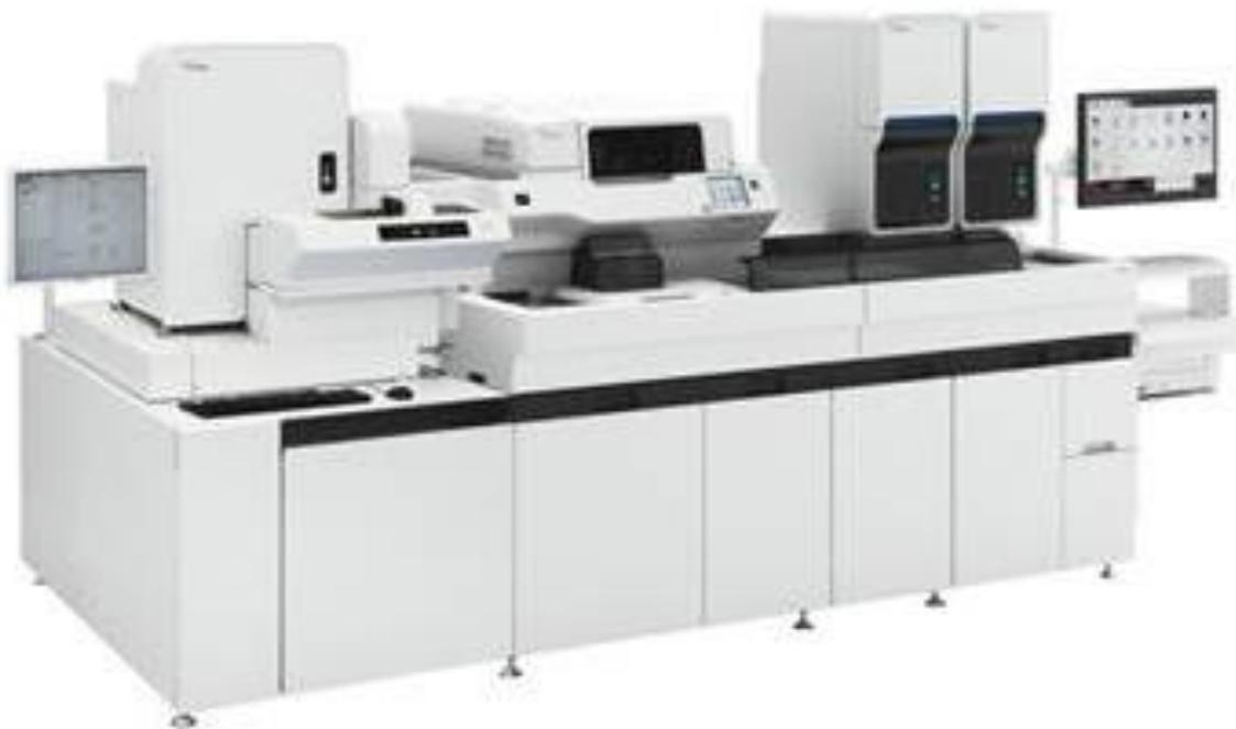
Slika 19. Integrirani automatski uređaj za razmaz krvi Sysmex DI-60 [14]
