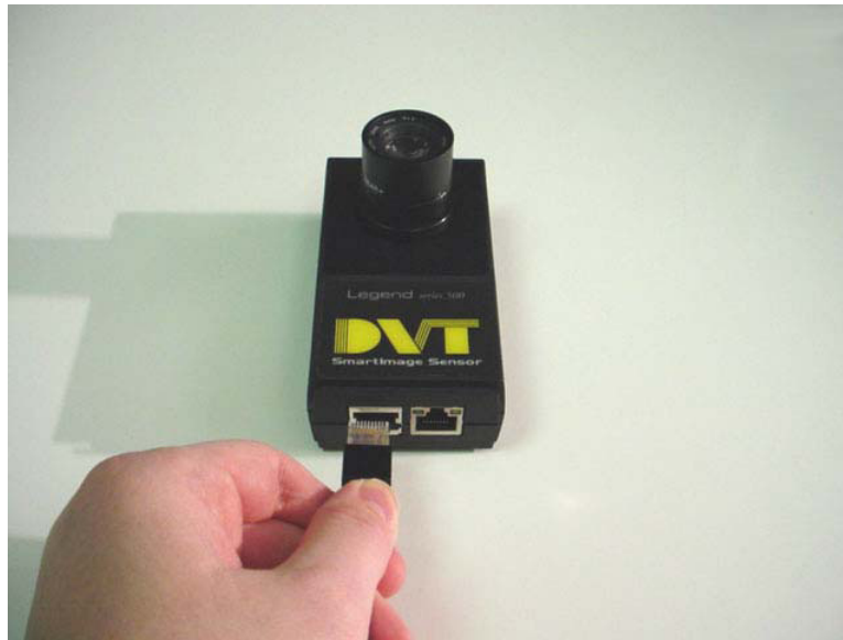
Slika 9. Napajanje senzora, Digitalni I/O konektor
