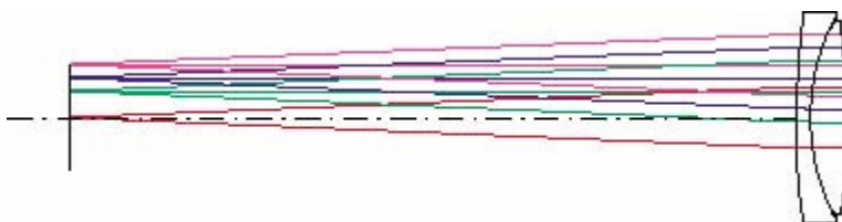
Slika 17. Telecentrična leća- prikaz određenih točaka objekta duž linije gledanja- uočiti paralelne linije na leći
