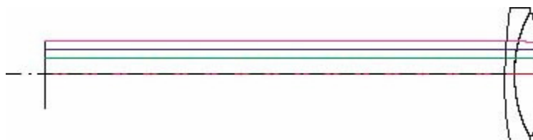
Slika 18. Telecentrična leća, prikaz glavnih zraka nekog predmeta ili slike, primijetimo da su linije paralelne.
