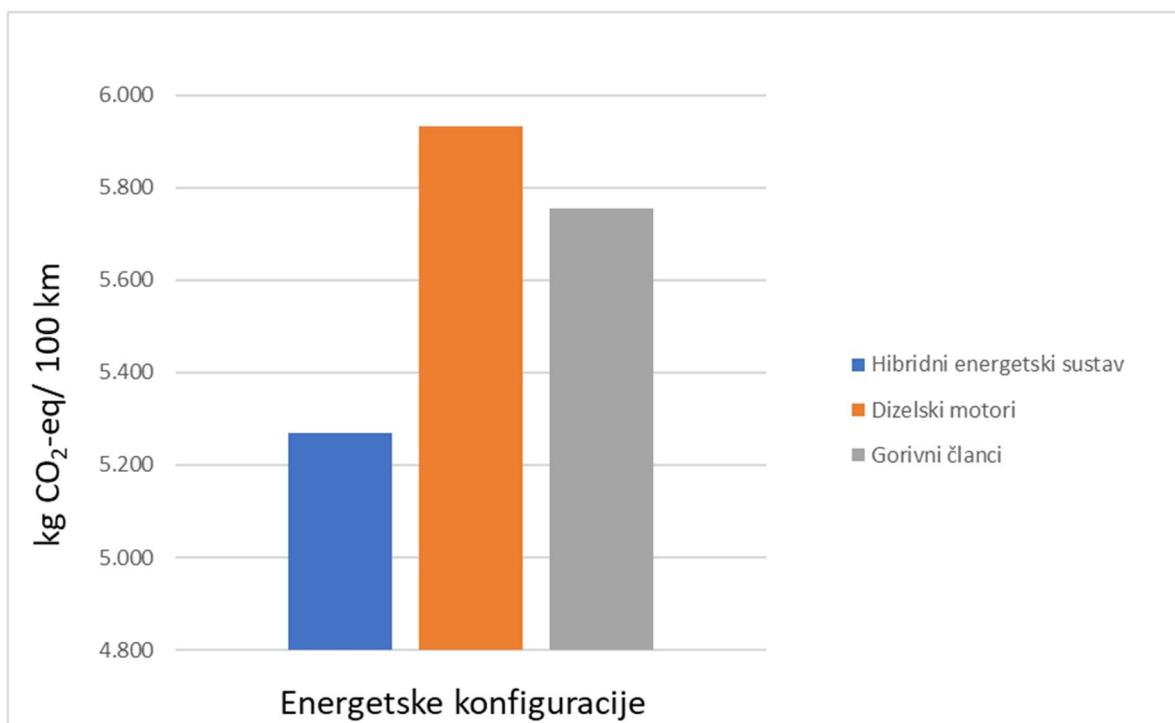
**Slika 21. Ugljični otisak energetskih konfiguracija**
