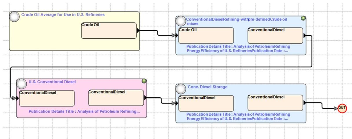
Slika 15. Put nastanka dizelskog goriva (Well To Pump)
