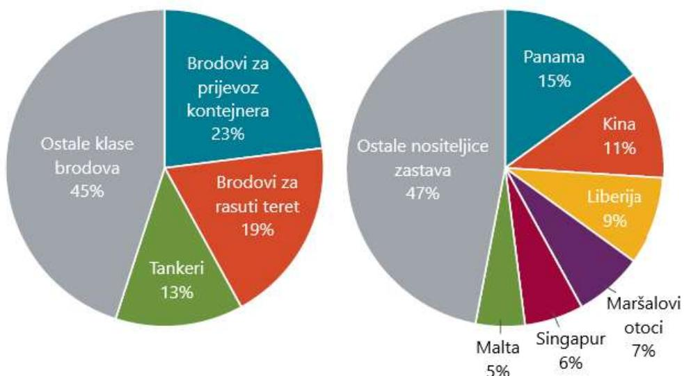
Slika 6. Udio emitiranog CO<sub>2</sub> po tipu broda i zastavi, 2013-2015 [6]
