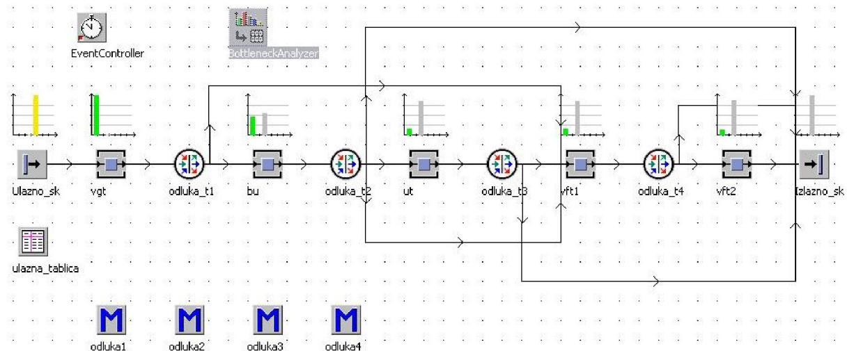
Slika 7.18. Primjena objekta BottleneckAnalyzer
