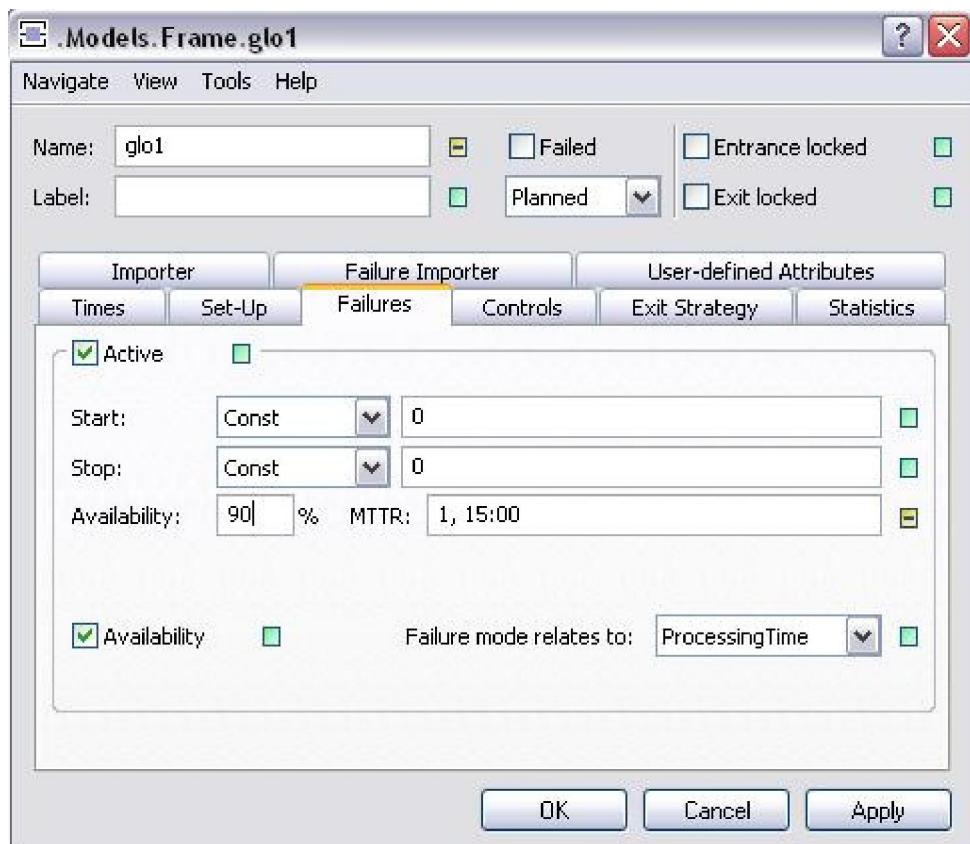
Slika 7.31. Dostupnost stroja za glodanje stavljamo na 90%
