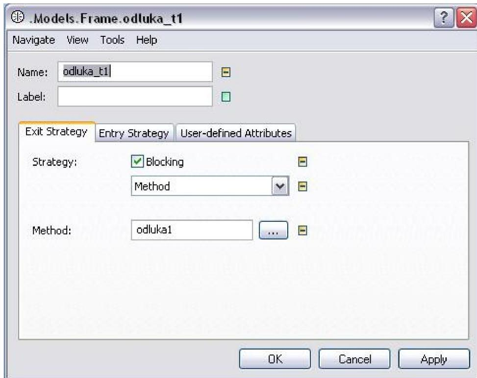
Slika 6.10. Povezivanje objekta FlowControl i objekta Method
