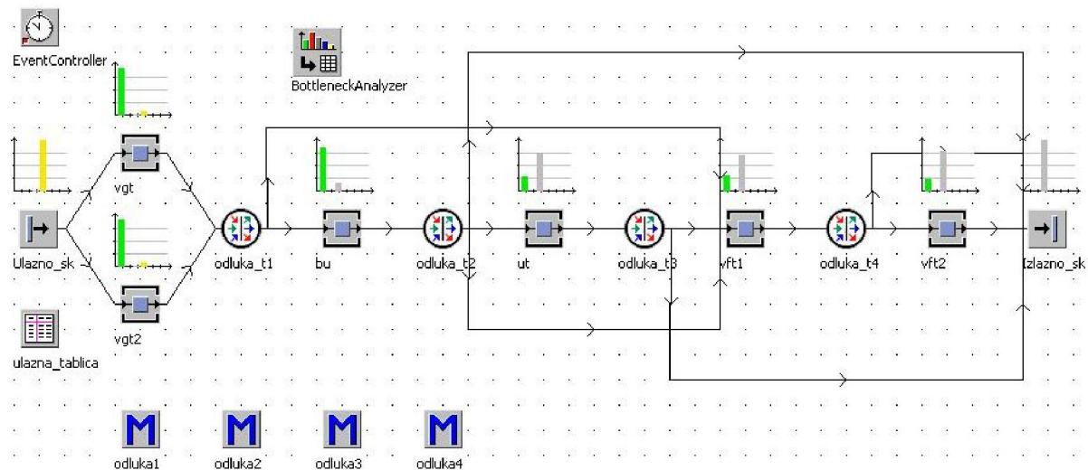
Slika 7.22. Model simulacije s dva vgt stroja i BottleneckAnalyzer
