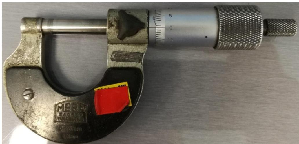
Slika 14. Mikrometar
