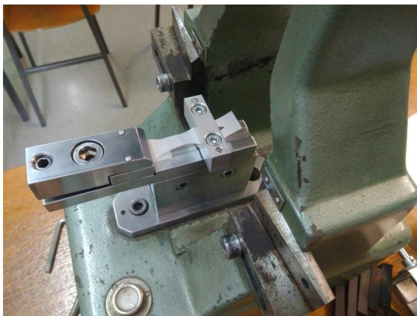
Slika 16. Ispitno tijelo na Charpyjevom klatnu
