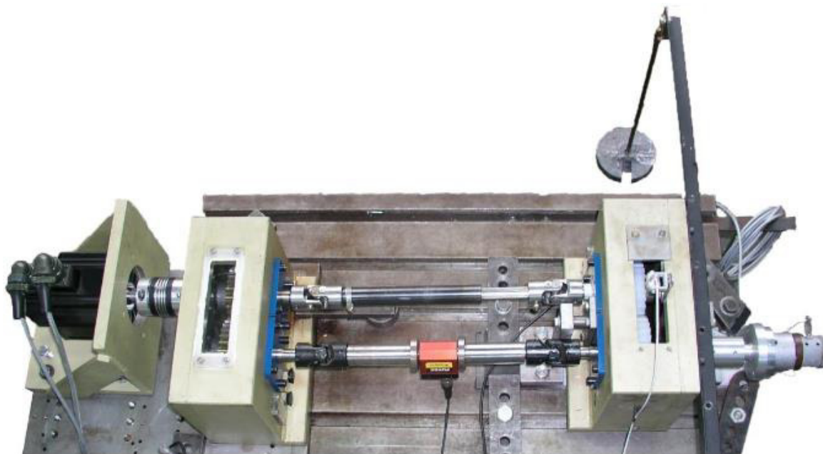
Slika 23. Realna izvedba uređaja za ispitivanje zupčanika (FSB) [4]
