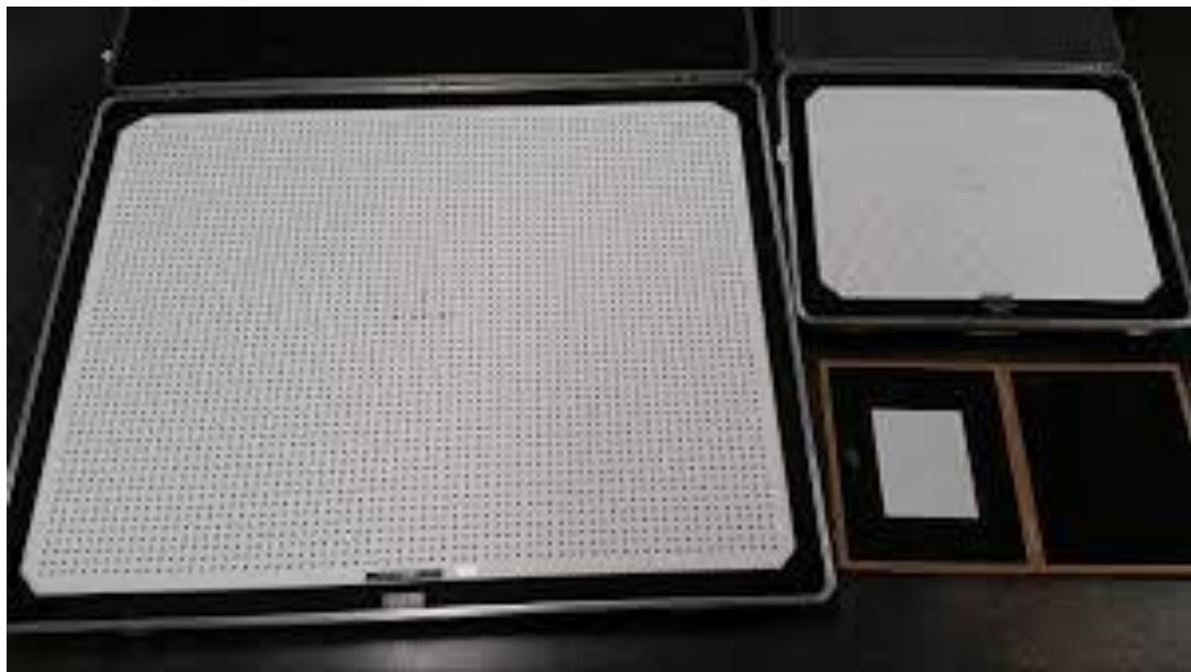
Slika 46. Kalibracijski 2D objekti
