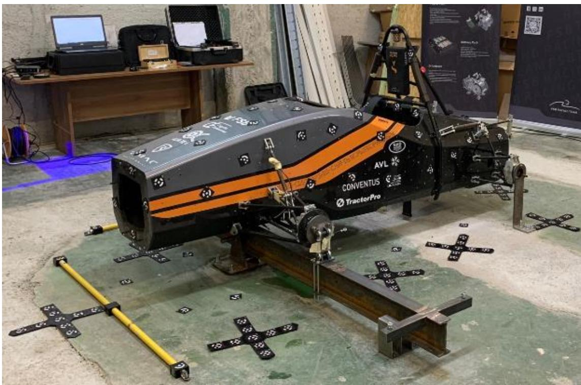
**Slika 55. Bolid pripremljen za referentno mjerjenje**
