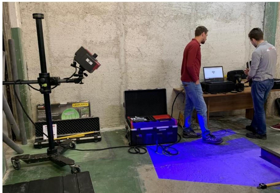
Slika 74. Zagrijavanje ATOS Triple Scan uređaja
