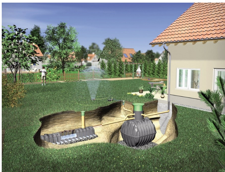
Slika 11. Podzemni spremnici za prikupljanje kišnice [32]
