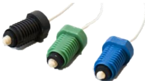
Slika 6.2 EEG elektrode na bazi vode [1]
