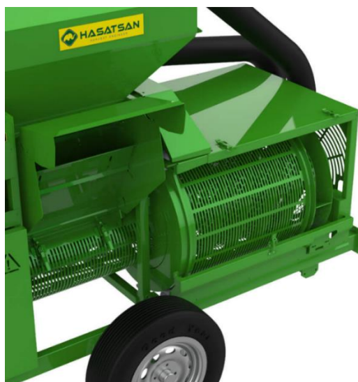
Slika 41. H2200 - prikaz mrežastih bubnjeva za filtraciju plodova
