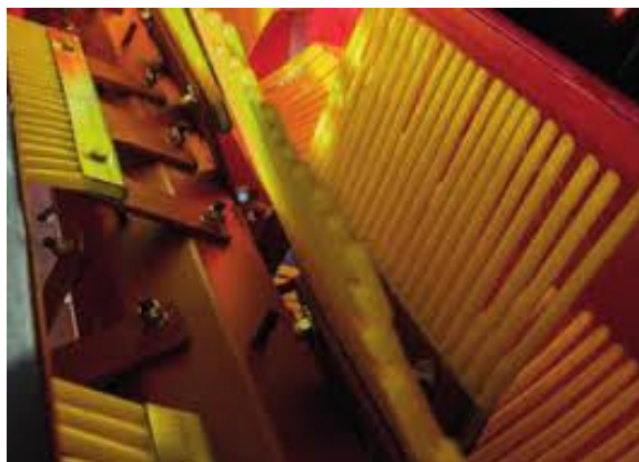
Slika 37. TR 200.2 - prikaz mehanizma sa četkicama za skupljanje plodova
