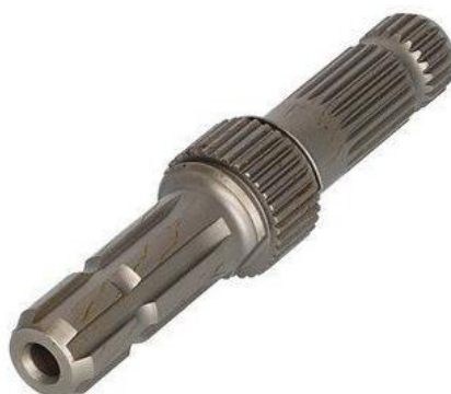
Slika 21. Izlazno radno vratilo traktora
