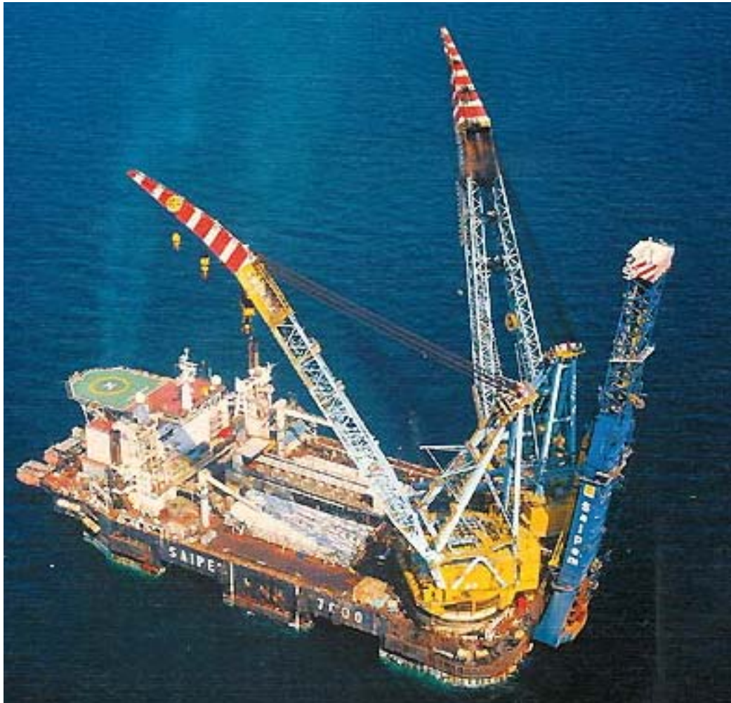
Slika 2.7 Najveća plovna dizalica na svijetu Saipem 7000 kapaciteta dizanja 7000t. Na krmi vidimo instaliranu rampu za polaganje cjevovoda J – tipom
