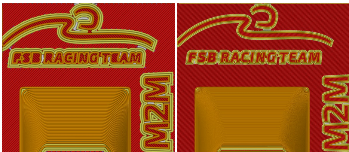
Slika 44 Usporedba kvalitete za mlaznicu od 0,8 mm (lijevo) i 0,4 mm (desno)
