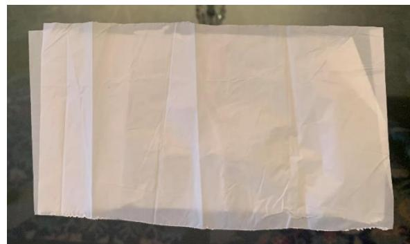
Slika 7.10. Biorazgradljiva škrobna folija
