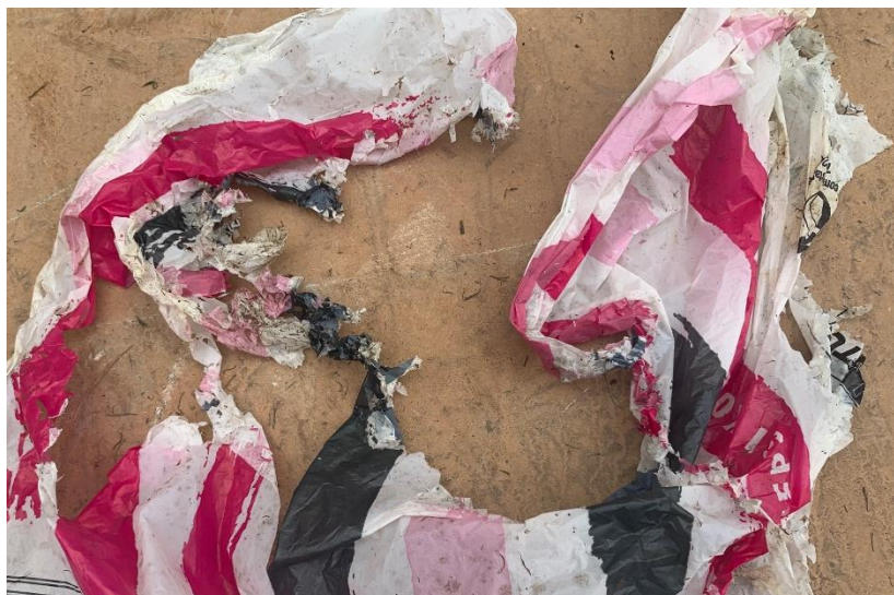
Slika 7.15. Folija u procesu biorazgradnje
