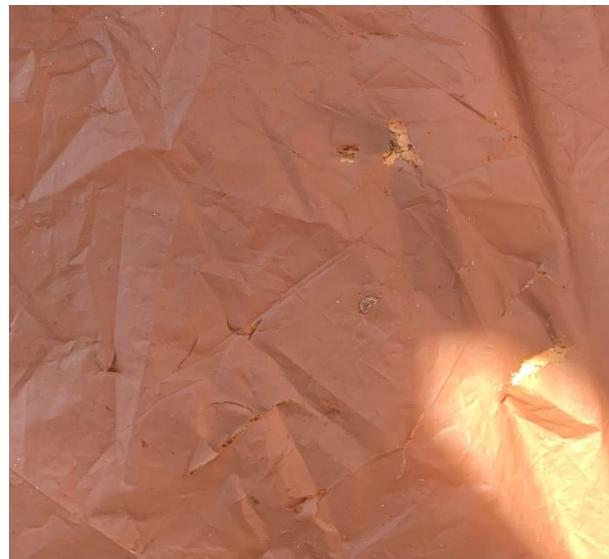
**Slika 7.14. Početak biorazgradnje**
