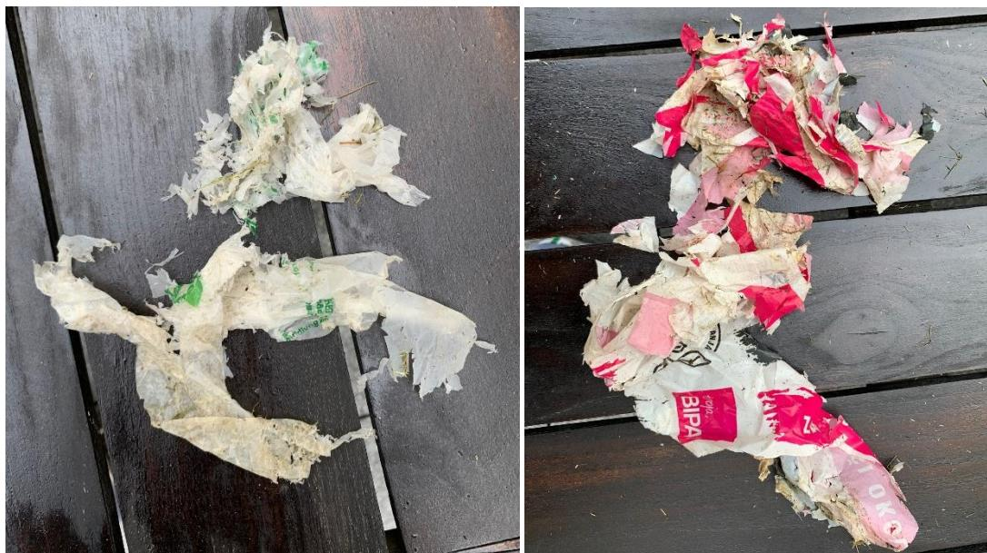
Slika 7.16. Biorazgrađeni ispitci nakon 4 mjeseca u vrtnom komposteru
