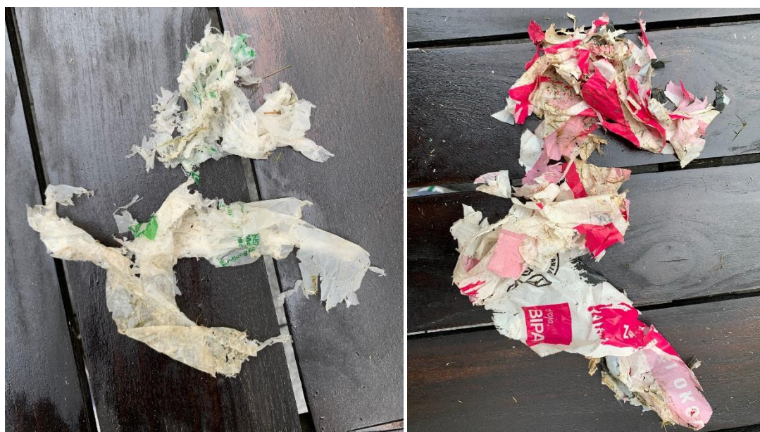
Slika 7.16. Biorazgrađeni ispitci nakon 4 mjeseca u vrtnom komposteru
