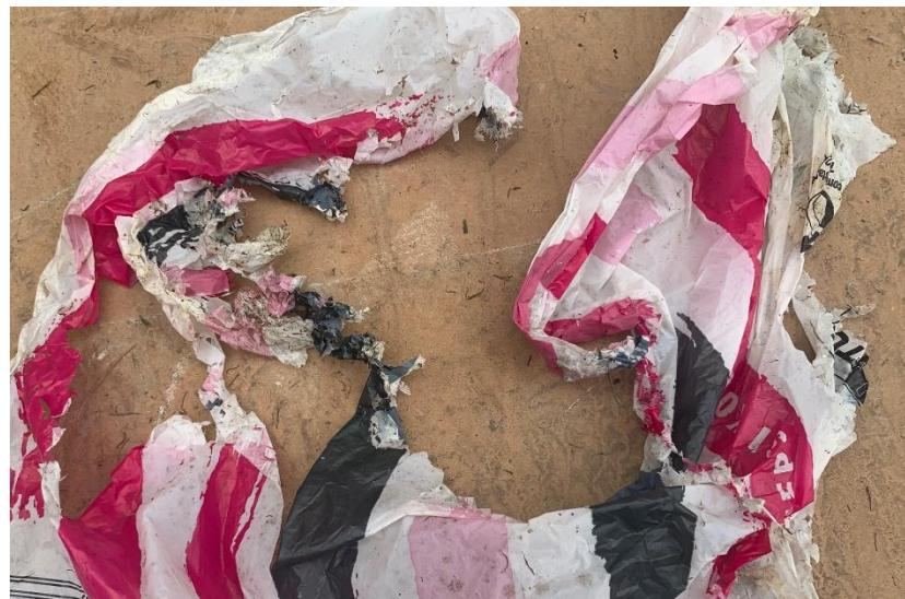
Slika 7.15. Folija u procesu biorazgradnje
