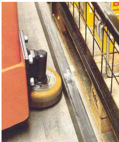
Slika 9. Mehanički sustav vođenja
