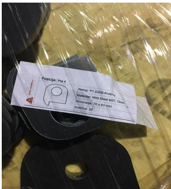
Slika 17. Označavanje pozicija izrezanih na laseru
