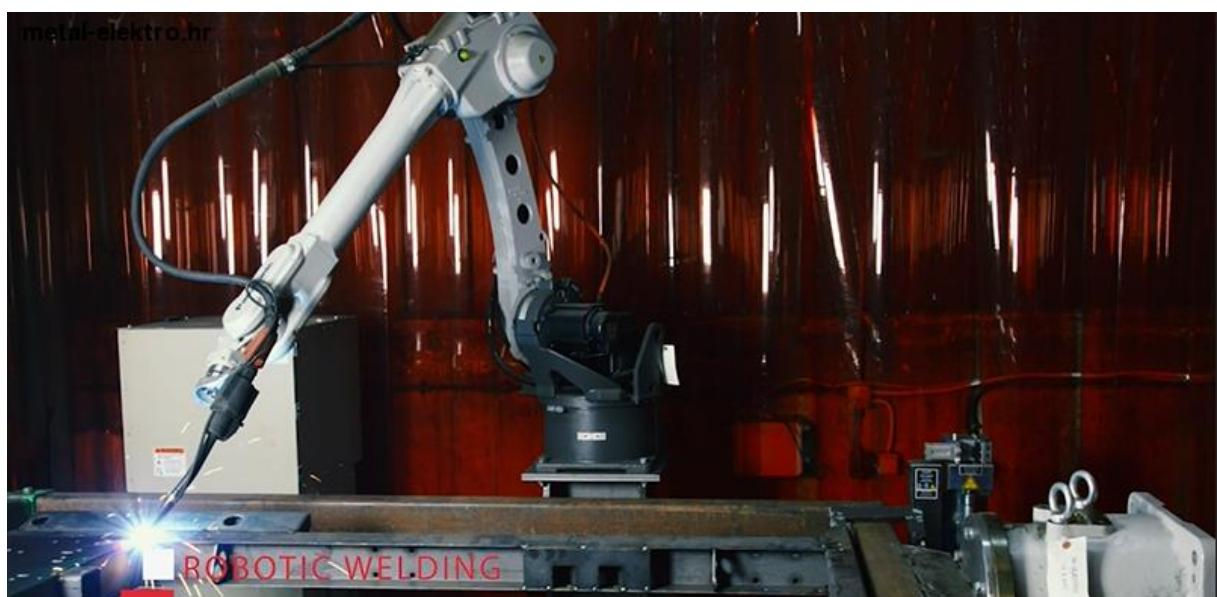
**Slika 12. Robot za zavarivanje [14]**
