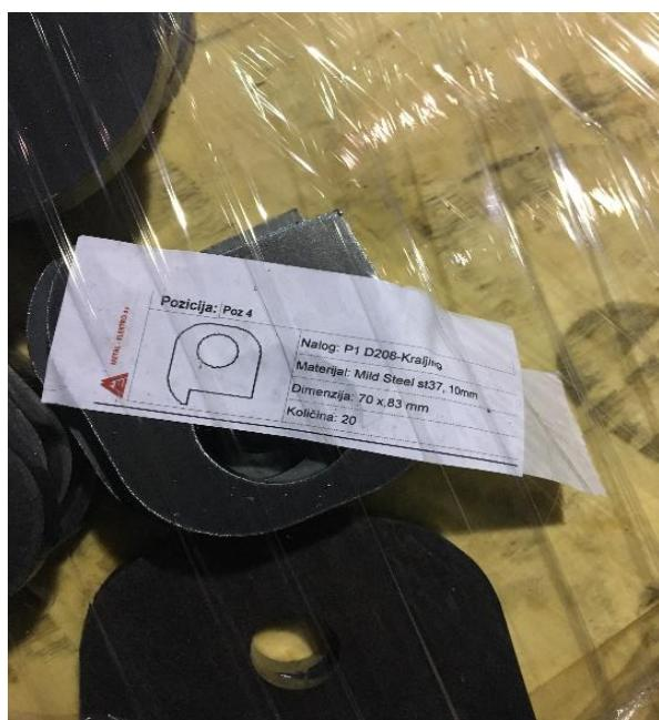
Slika 17. Označavanje pozicija izrezanih na laseru
