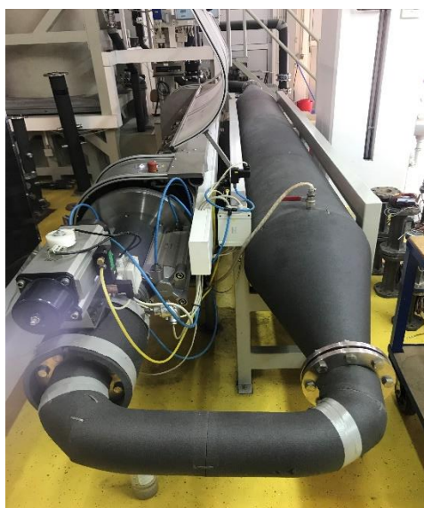
Slika 22. Smirivač protoka spojen na ispitnu klupu JUSTOR
