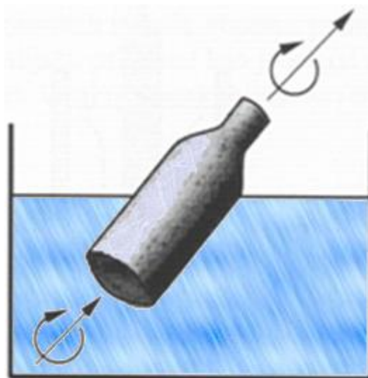
Slika 8. Pojednostavljen prikaz uranjanja i okretanja [1].
