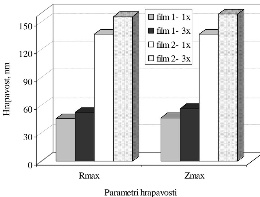
Slika 24. Grafički prikaz vrijednosti parametara hrapavosti površine sol-gel  $\text{TiO}_2$  prevlaka za film 1 i film 2 (1x: sloj nanesen uranjanjem u sol 1 jedanput; 3x: sloj nanesen uranjanjem u sol 2 tri puta). Usporedna vrijednost parametara hrapavosti analiziranih presjeka skenirane površine  $10 \cdot 10 \mu\text{m}$ .
