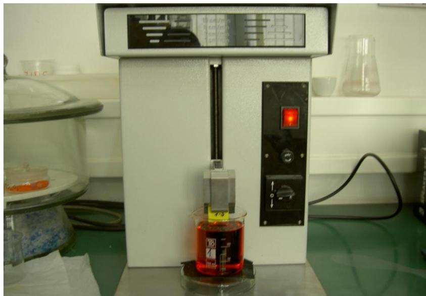
*Slika 16. Uranjanje staklene pločice u sol*
