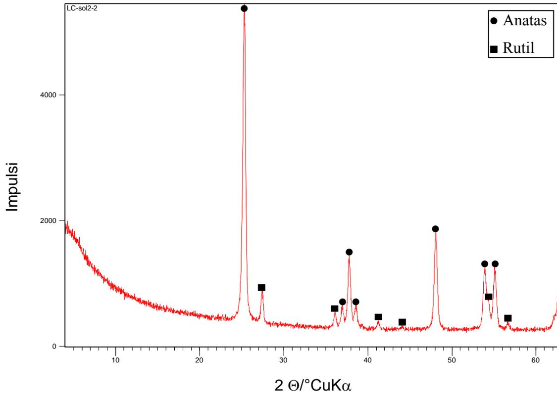
Slika 26. Difraktogram  $\text{TiO}_2$  – Sol 2.
