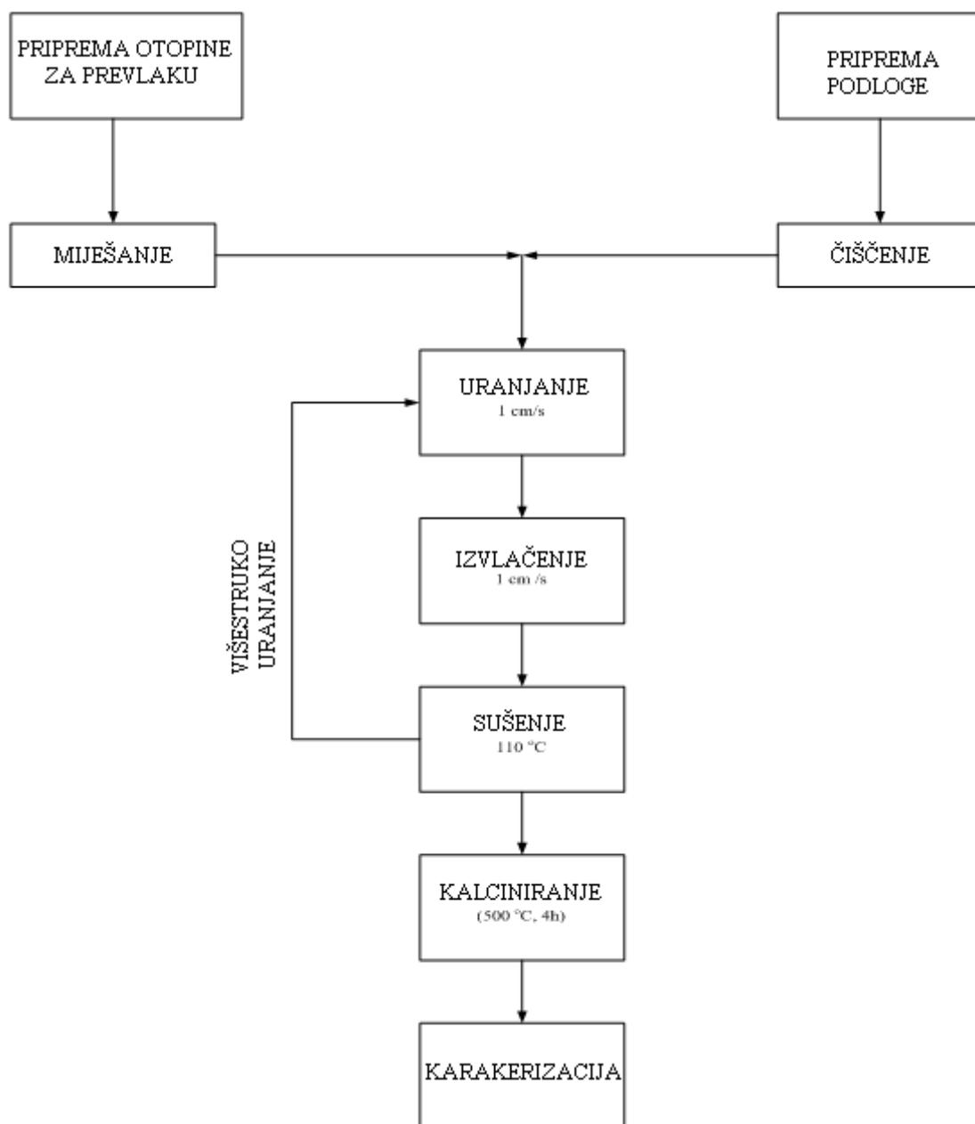
Slika 14. Shematski prikaz tijeka priprave sol-gel prevlake
