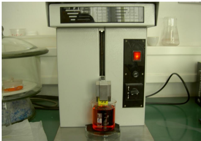
Slika 16. Uranjanje staklene pločice u sol
