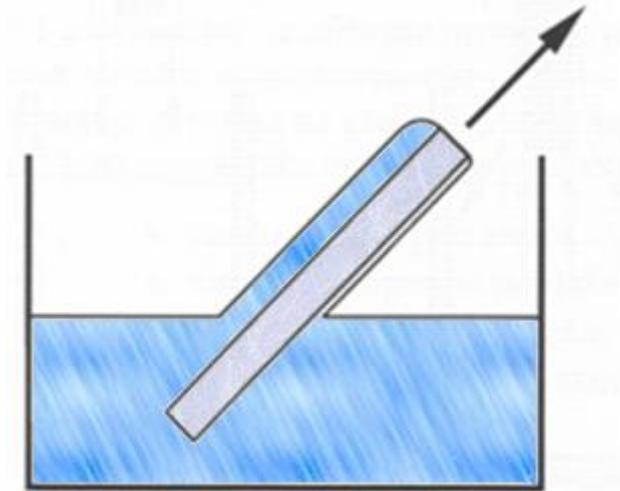
Slika 7. Pojednostavljeni prikaz postupka uranjanja pod kutom [1].
