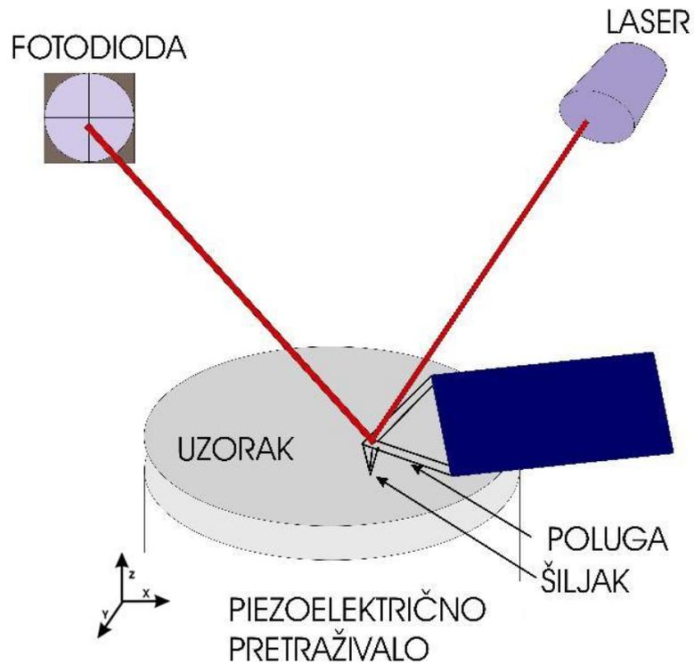
Slika 12. Shematski prikaz principa rada AFM-a [7].
