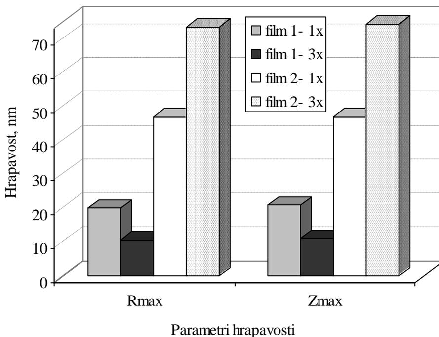
Slika 23. Grafički prikaz vrijednosti parametara hrapavosti površine sol-gel  $\text{TiO}_2$  prevlaka za film 1 i film 2 (1x: sloj nanesen uranjanjem u sol 1 jedanput; 3x: sloj nanesen uranjanjem u sol 2 tri puta). Usporedna vrijednost parametara hrapavosti analiziranih presjeka skenirane površine  $2 \cdot 2 \mu\text{m}$ .
