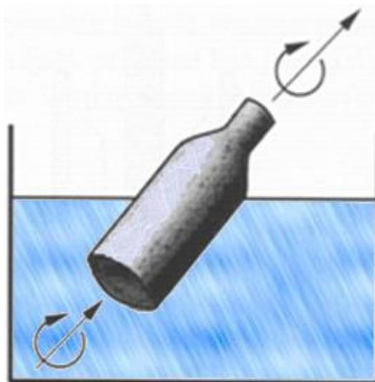
Slika 8. Pojednostavljen prikaz uranjanja i okretanja [1].
