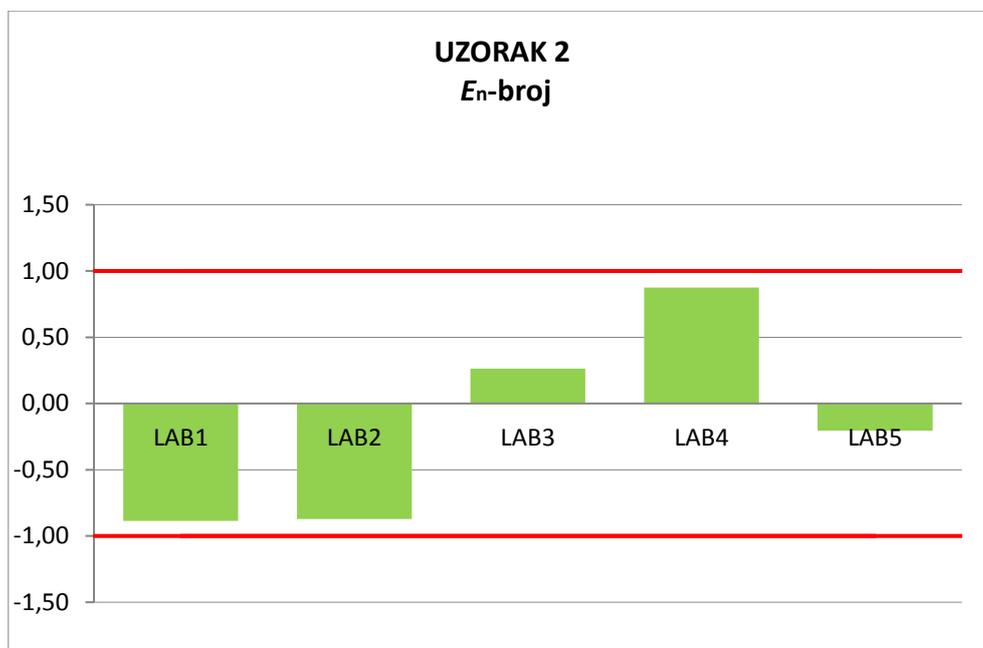
Slika 11. Dijagram  $E_n$ -brojeva za uzorak 2
