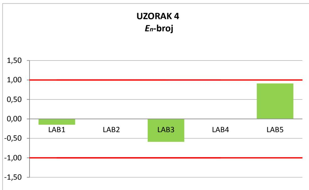
Slika 20. Dijagram  $E_n$ -brojeva za uzorak 4 nakon izbacivanja LAB2 i LAB4 iz analize i zadovoljavanja Birge-ovog kriterija
