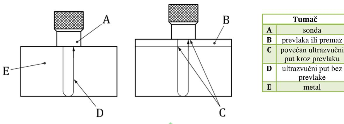
Slika 4. Povećani ultrazvučni put kroz premaz [3]
