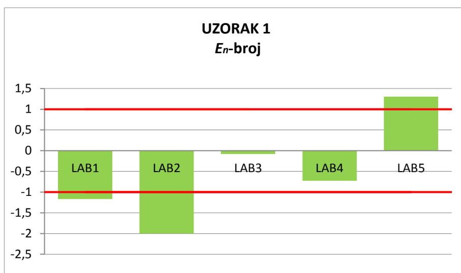
Slika 9. Dijagram  $E_n$ -brojeva za uzorak 1
