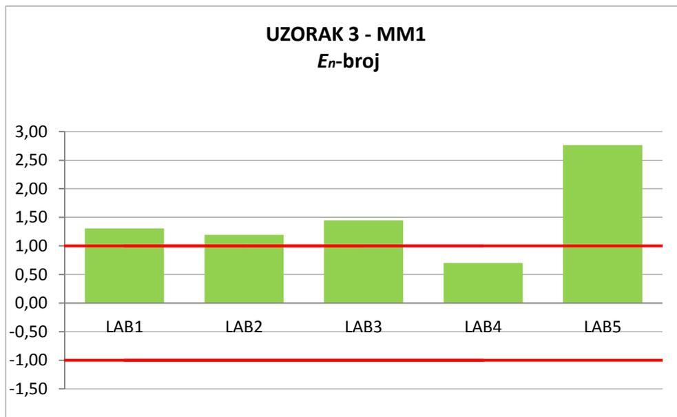
Slika 13. Dijagram  $E_n$ -brojeva za uzorak 3 – MM1
