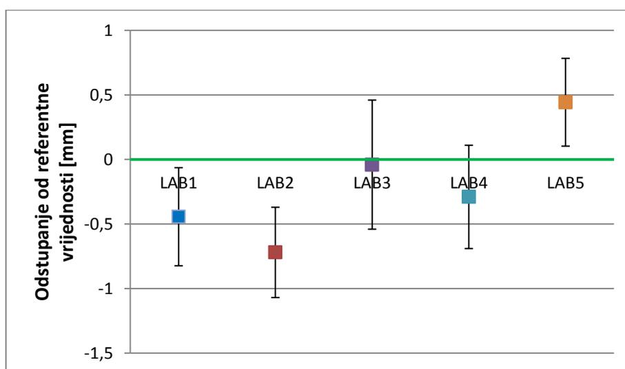
Slika 10. Odstupanje od referentne vrijednosti s pripadajućim mjernim nesigurnostima za uzorak 1
