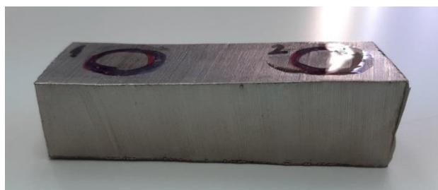
**Uzorak 3: uzorak s neparalelnim površinama**
