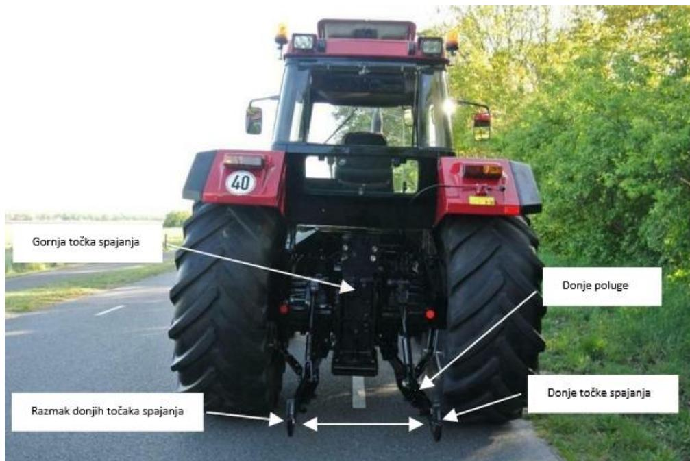
Slika 4. Traktorski priključak u 3 točke [8]
