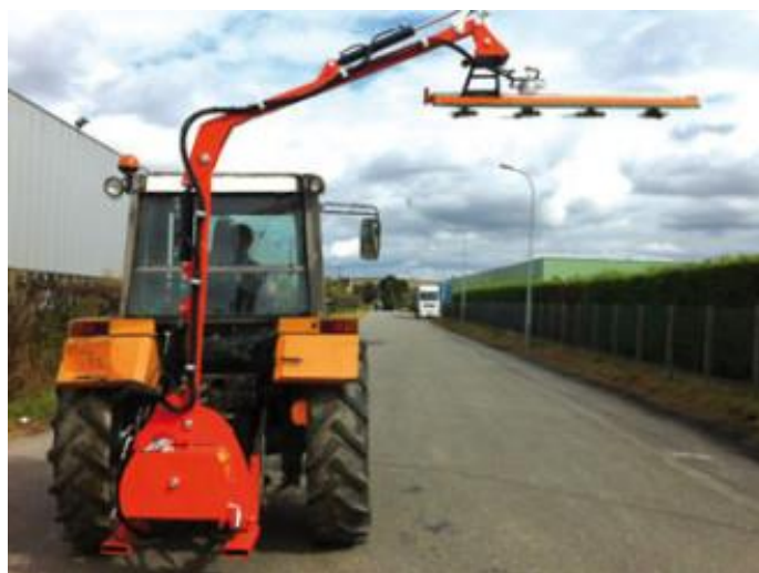
Slika 15. Sjekač granja Cobra [17]
