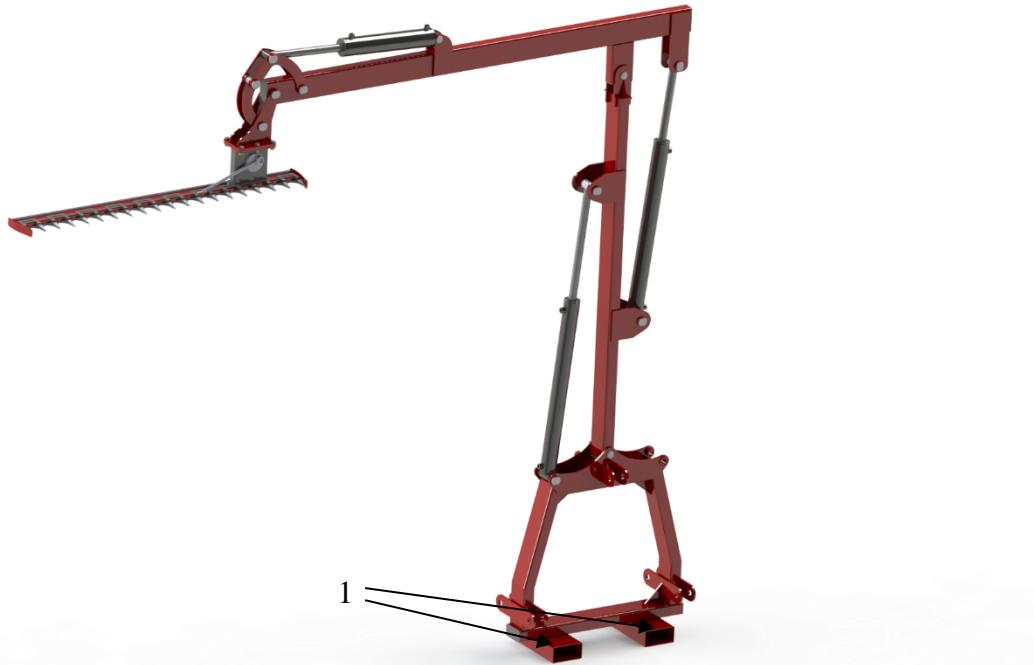
**Slika 37. Sjekač granja na hidrauličnoj ruci**
