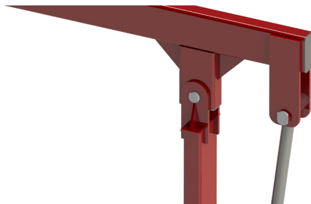
Slika 30. Zglobna veza između segmenta 1 i segmenta 2
