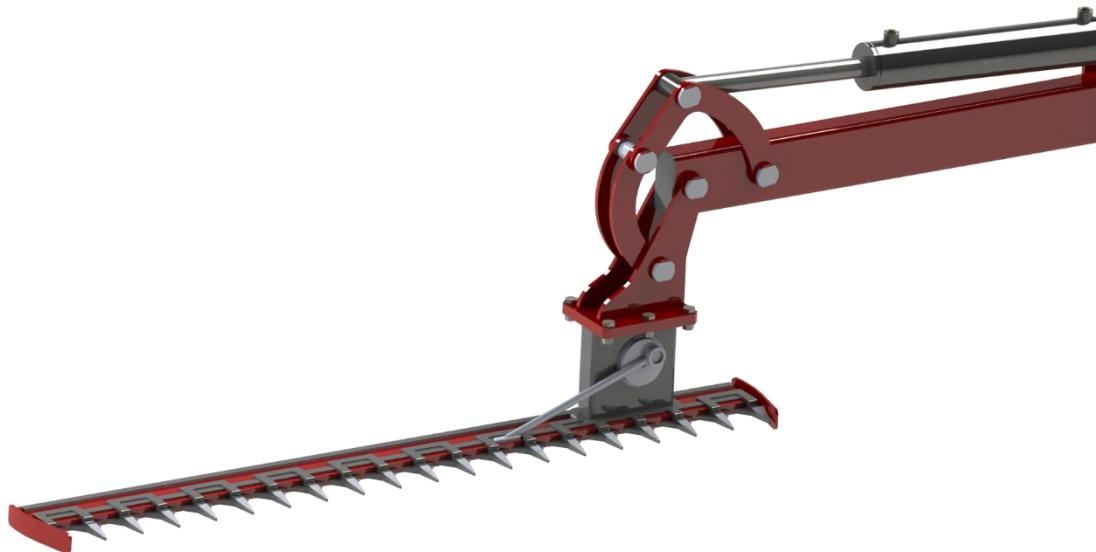
**Slika 39. Prikaz kosišta i mehanizma za rotaciju kosišta**
