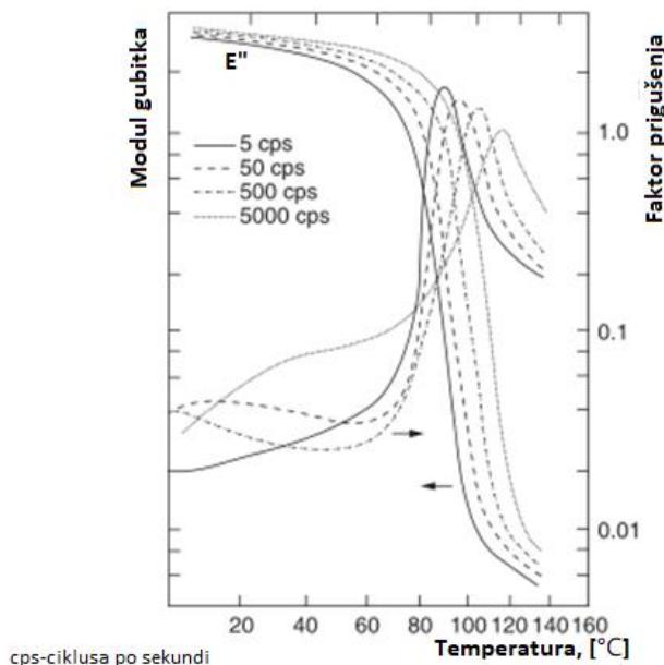
Slika 3.5 Utjecaj frekvencije na DMA rezultate PVC uzorka
