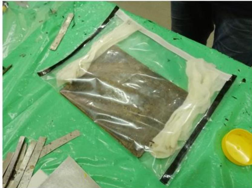
Slika 5.6 Izradak prije vakuumiranja i prešanja
