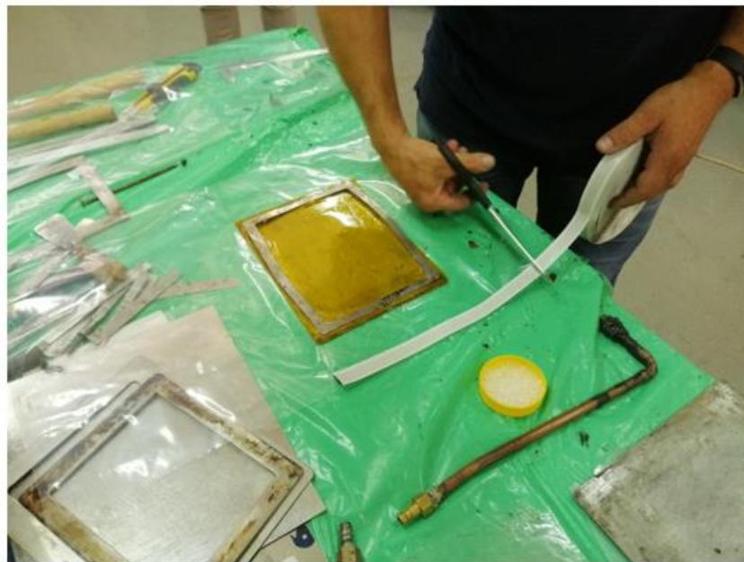
Slika 5.4 Priprema kalupa i vakuum folije
