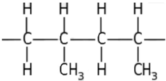
Slika 2.4 Izotaktni polipropilen (polimer s malim bočnim skupinama)
