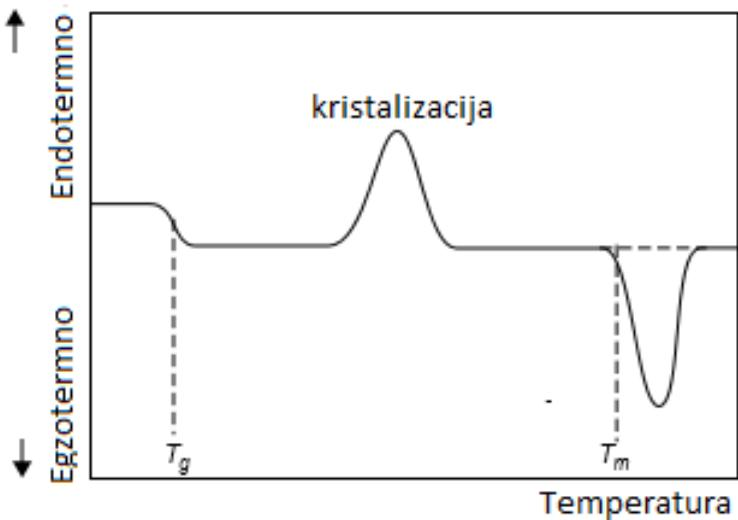
Slika 1.2 Shematska krivulja dobivena DSC metodom [3]
