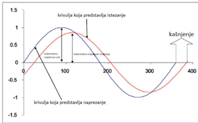
Slika 3.10 Naprezanje i istezanje prilikom dinamičko-mehaničke analize. [20]
