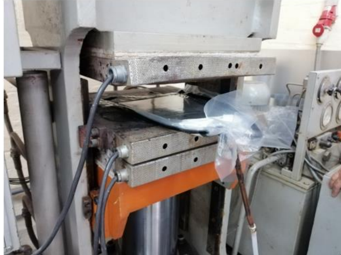
Slika 5.8 Stavljanje kalupa u prešu
