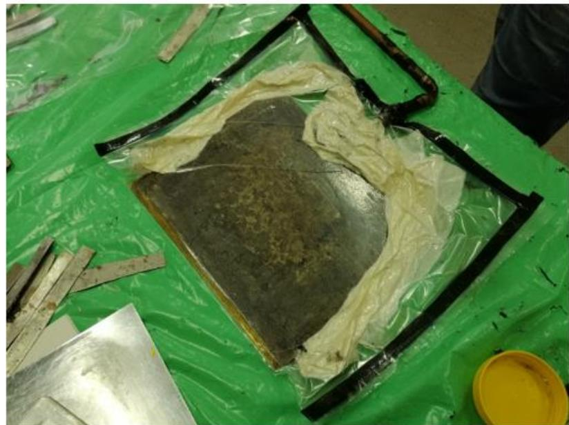
Slika 5.7 Vakuumiranje
