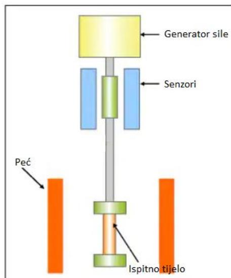
Slika 3.9 Grafički prikaz vlačne dinamičko-mehaničke analize [19]
