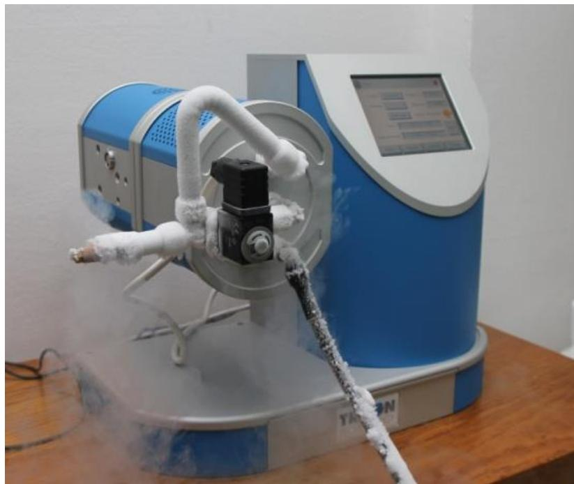
Slika 5.2 Korišteni DMA uređaj [32]
