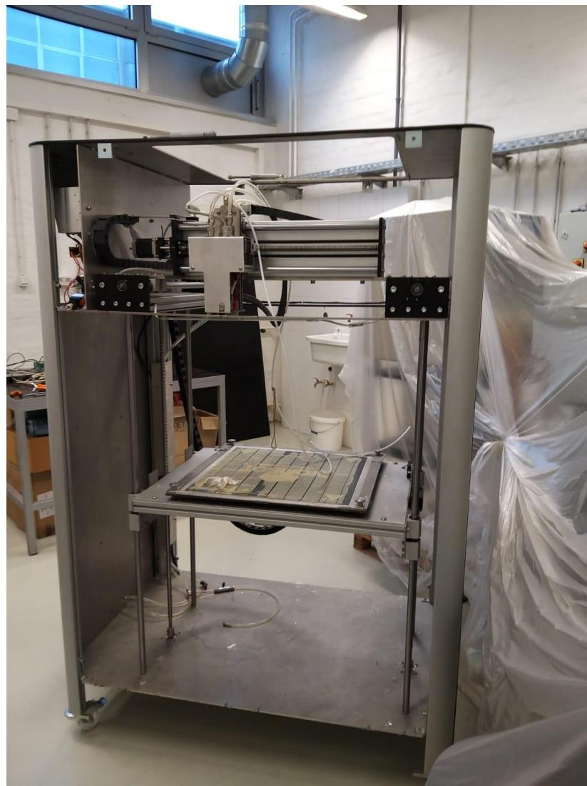
Slika 13. Komercijalni stroj za taložno očvršćivanje
