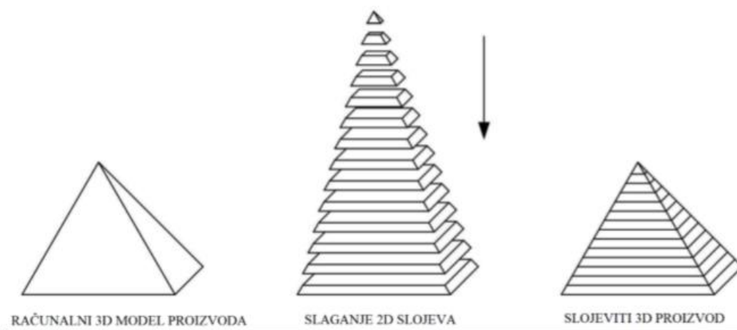
Slika 3. Postupak izrade do 2D slojeva do 3D oblika proizvoda [2]
