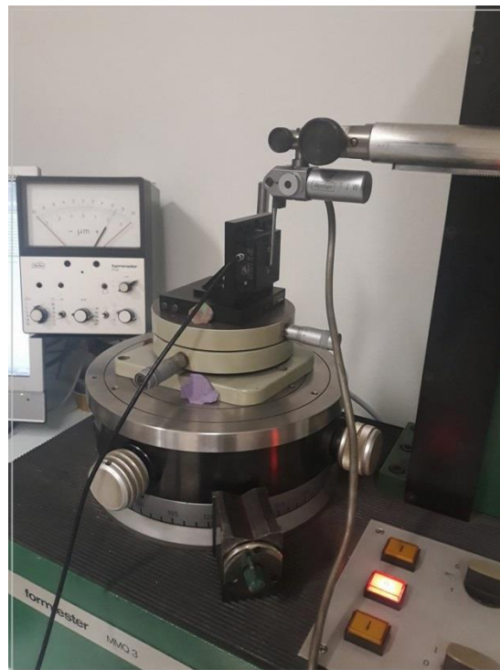
Slika 40 Postavljanje piezo aktuatora na MMQ-3 uređaj [2]
