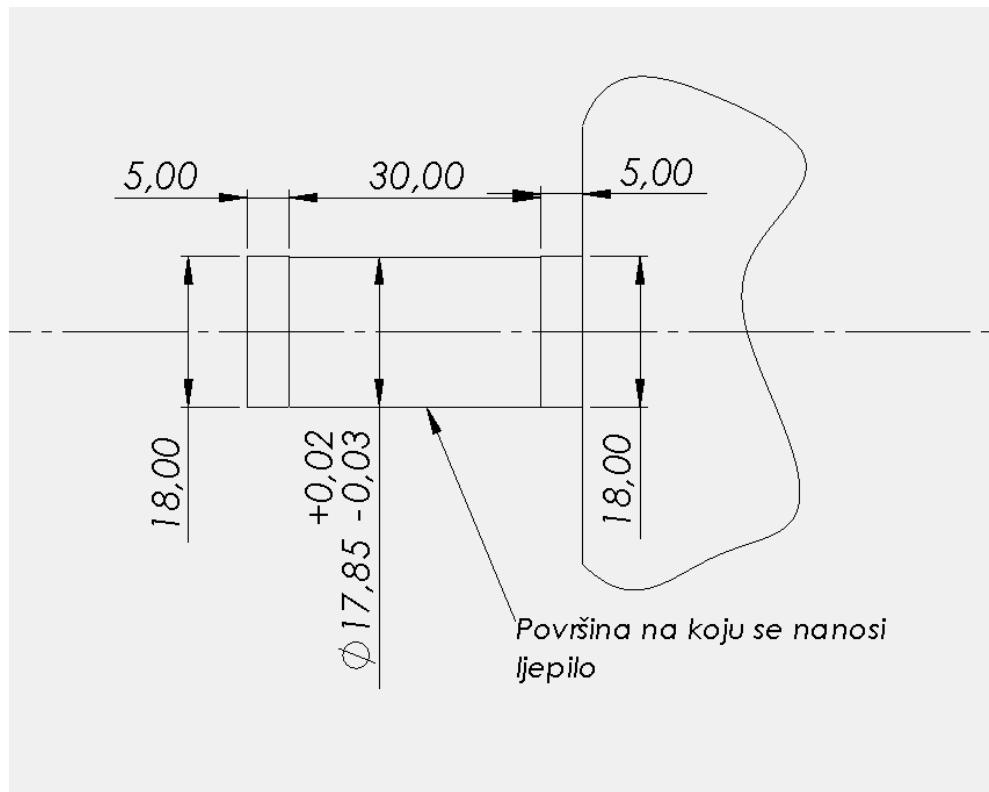
**Slika 26. Izvedba lijepljenog spoja**
