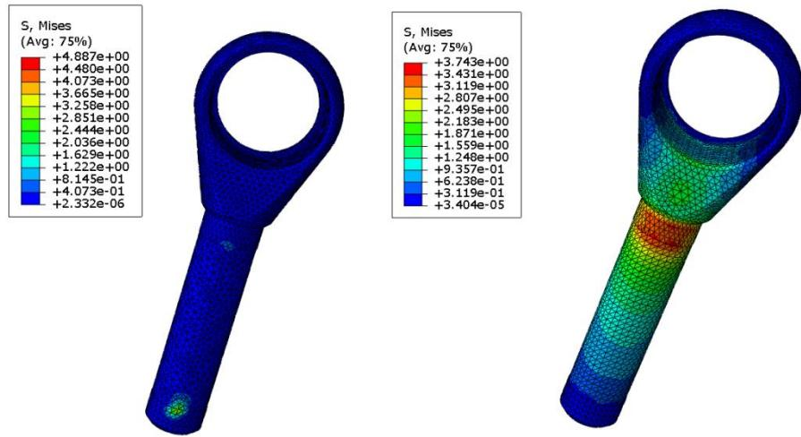
Slika 82. Naprezanja na gornjim unutarnjim elementima za prihvat zglobovnog ležaja, Skid pad
