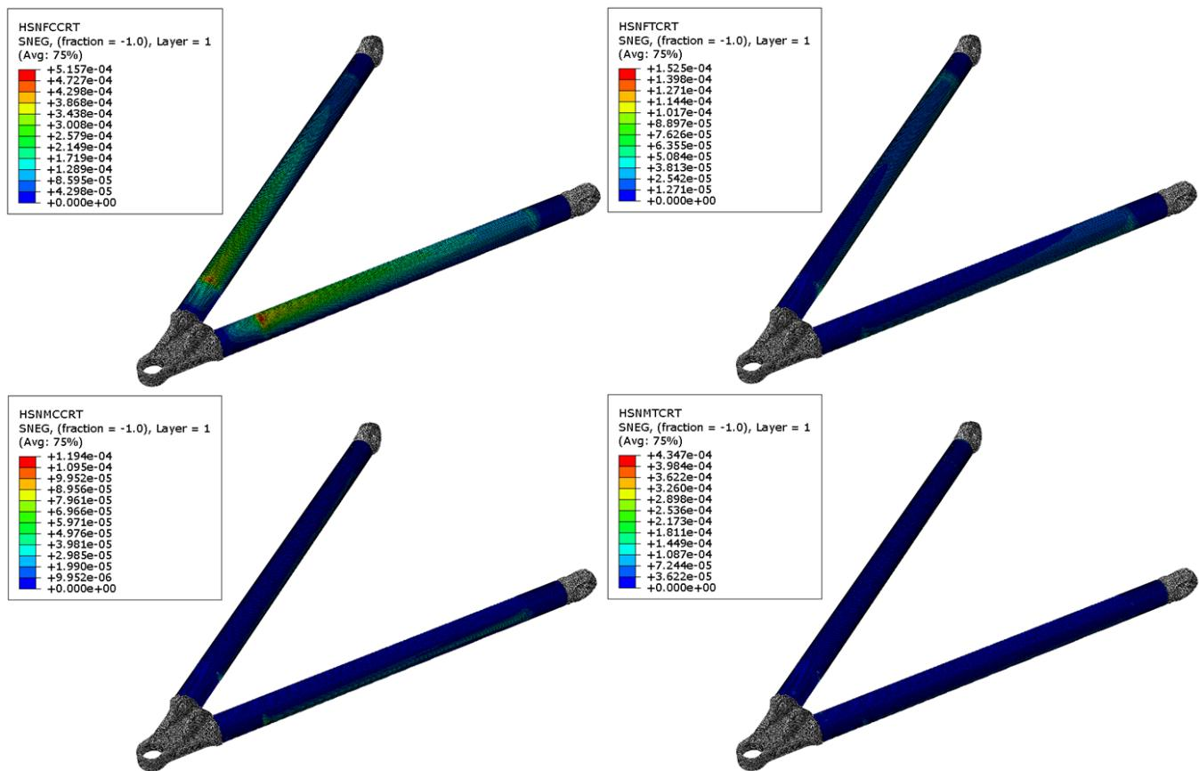
Slika 78. Naprezanja na cijevima donjeg sklopa, *Skid pad*
