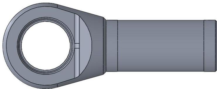
Slika 18. Prednji pogled na donji unutarnji element za prihvat zglobnog ležaja
