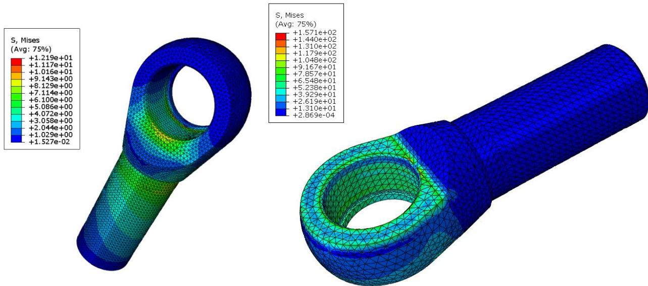
**Slika 68.** Statičko naprezanje na stražnjem donjem unutarnjem elementu za prihvatzgloboznog ležaja
