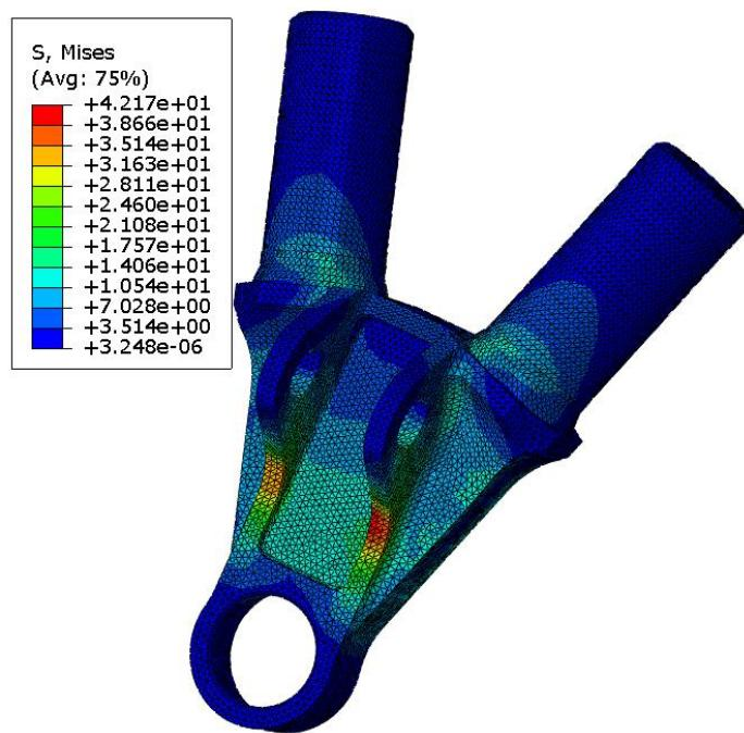
Slika 76. Naprezanja na vanjskom donjem elementu za prihvatanje zglobovnog ležaja, *Skid pad*
