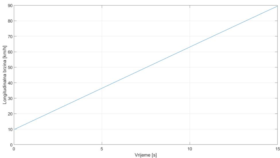
Slika 37. Promjena brzine u ovisnosti u vremenu prilikom ubrzanja vozila na zakriviljenoj putanji
