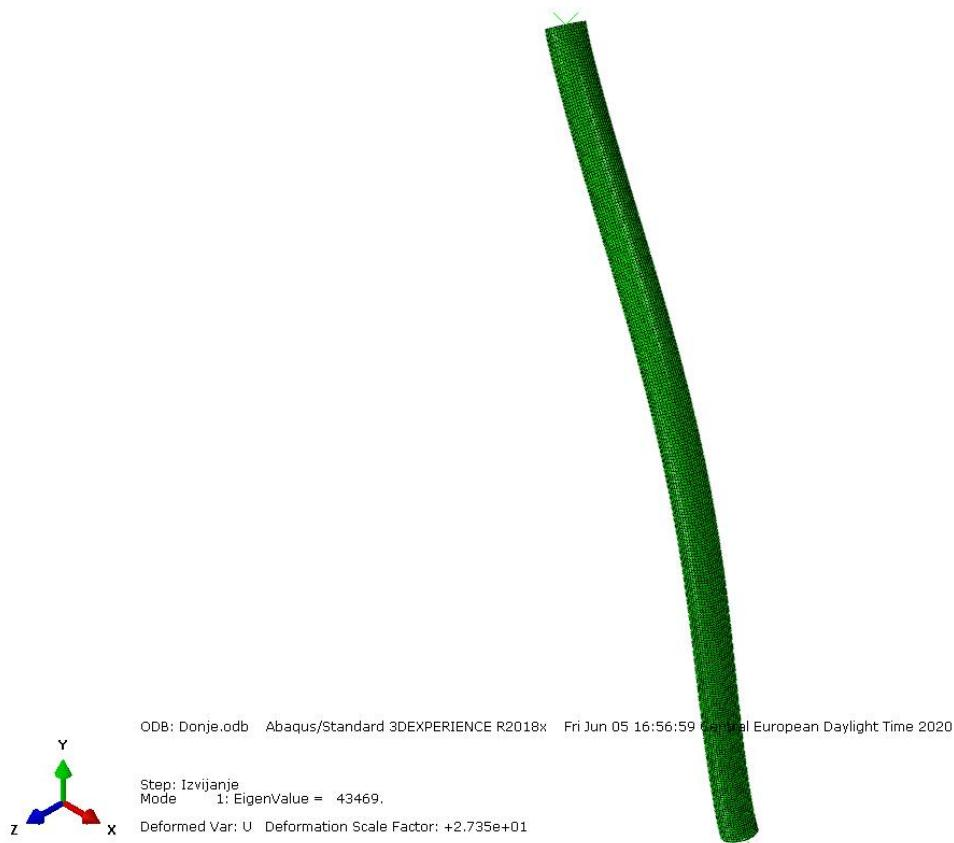
**Slika 88. Rezultati provedene analize na izvijanje na gornjoj cijevi**
