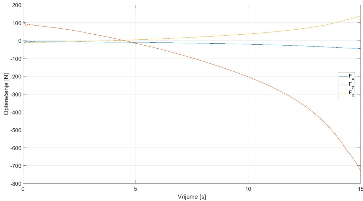
**Slika 40. Opterećenja na gornjem vanjskom prihvatu zglobnog ležaja prilikom ubrzavanja na zakrivljenoj putanji**
