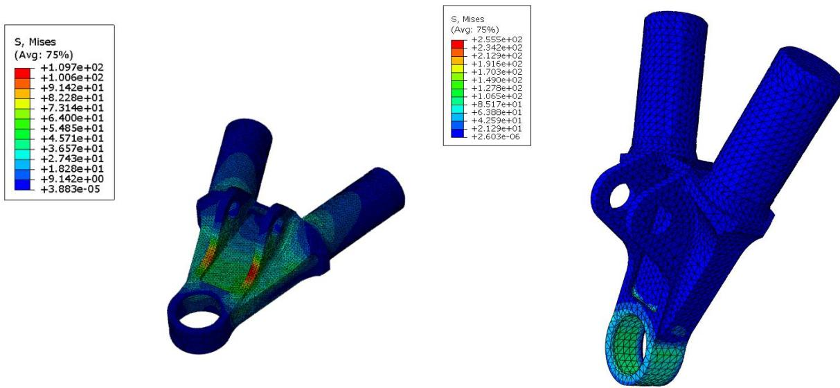
**Slika 65. Statičko naprezanje donjem vanjskog elementa za prihvata zglobnog ležaja**
