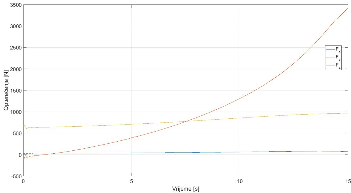
**Slika 39.** Opterećenja na donjem vanjskom prihvatu zglobovnog ležaja prilikom ubrzavanja na zakrivljenoj putanji
