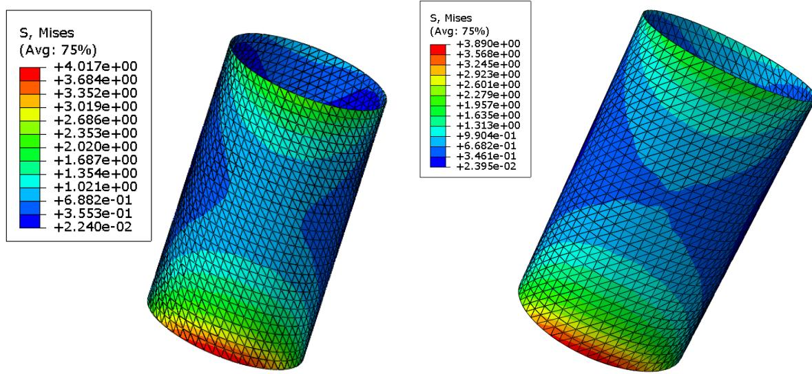
Slika 79. Naprezanja na vanjskim modelima ljepila donjeg sklopa, *Skid pad*
