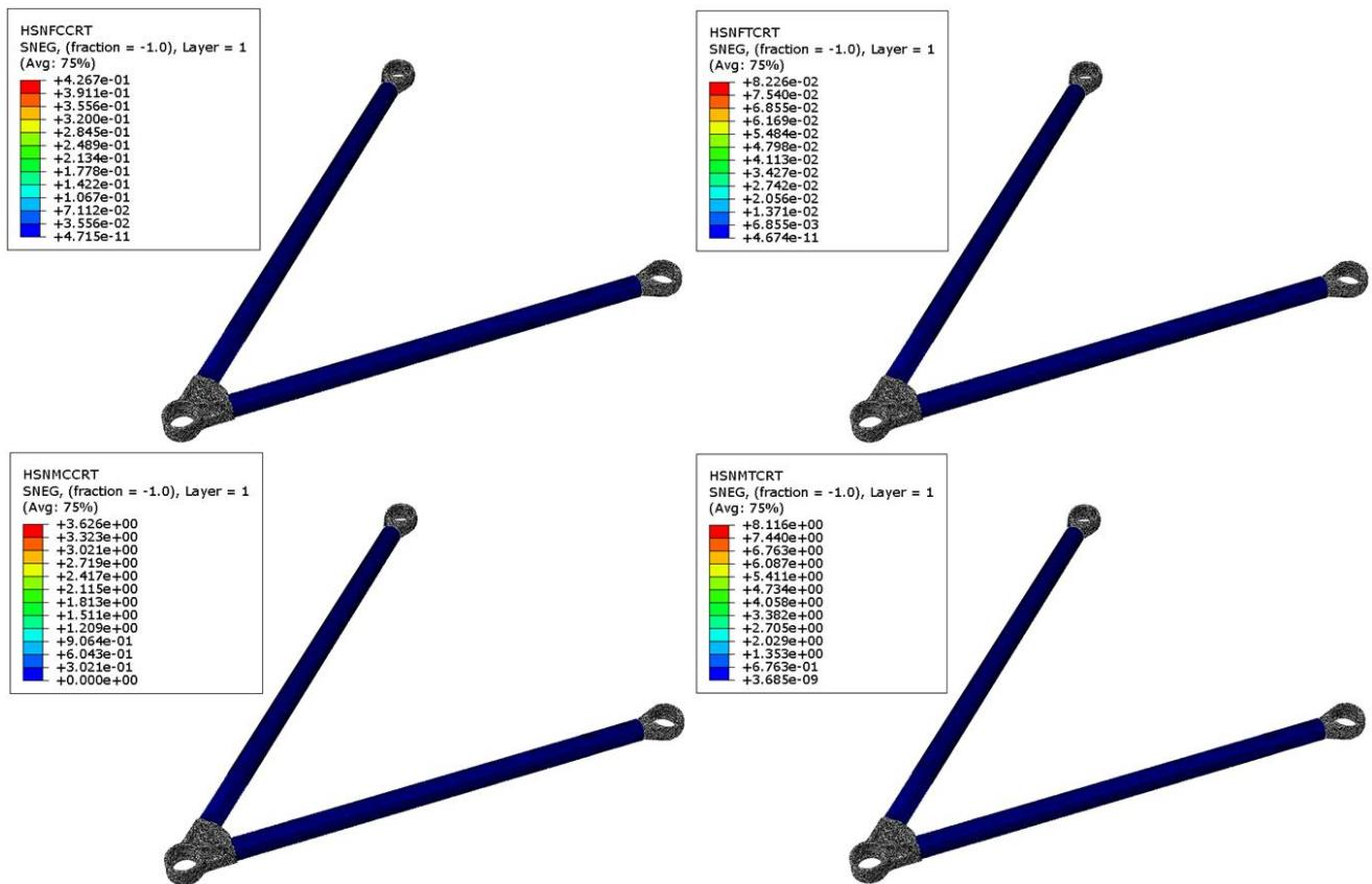
Slika 83. Naprezanja na cijevima gornjeg sklopa, Skid pad
