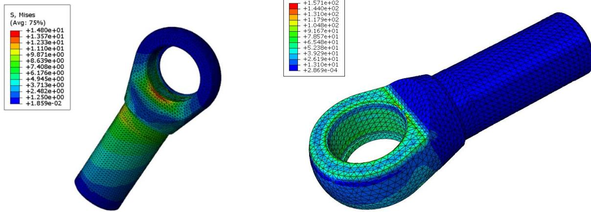
**Slika 67.** Statičko naprezanje na prednjem donjem unutarnjem elementu za prihvatzgloboznog ležaja
