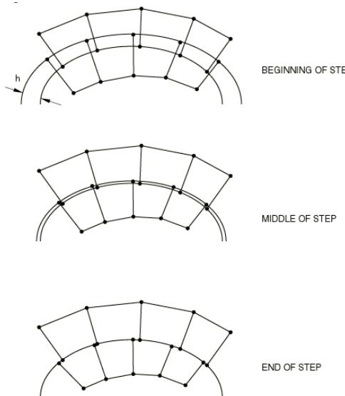
Slika 59. Shematski prikaz proračuna steznog spoja [20]
