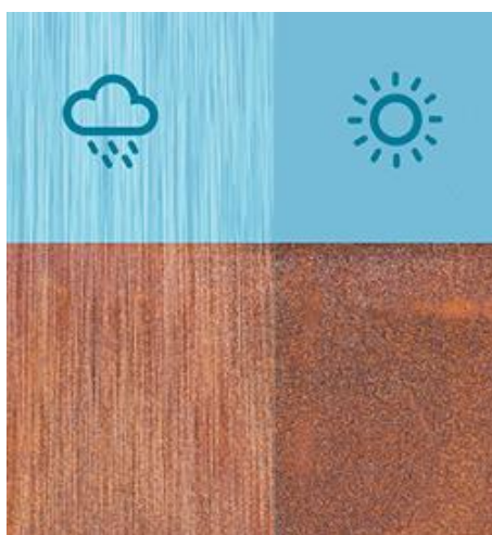
Slika 15. Naizmjenično vlaženje i sušenje površine čelika [28]
