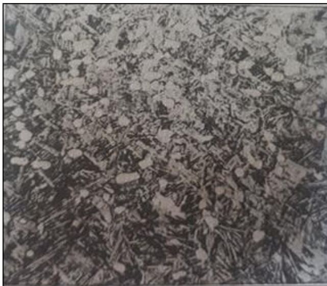
Slika 3. Mikrostruktura legure Ti - 6 Al – 4V [7]
