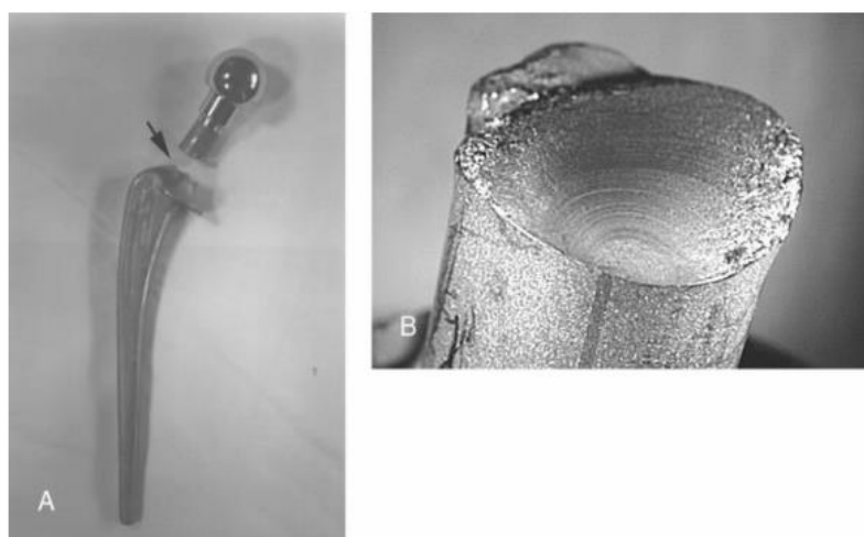
Slika 21. Lom zbog umora materijala [16]
