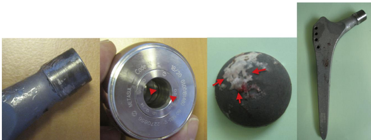
Slika 30. Prikaz trošenja Morse konusa i korozije na unutrašnjoj površini spoja [33]
