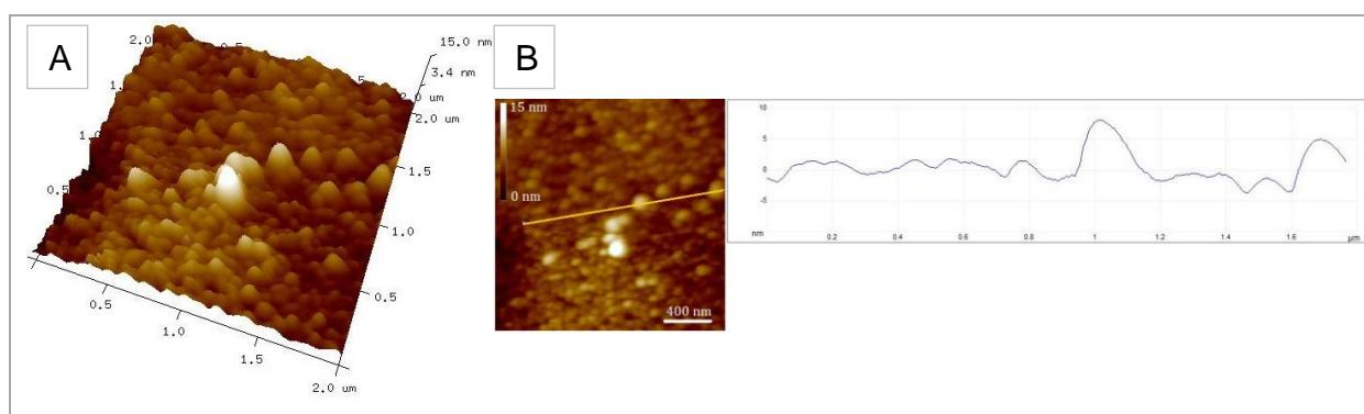
**Slika 24.** (A) 3-D AFM snimka površine ( $2 \times 2 \mu\text{m}$ ) uzorka 0,80% Ce-TiO<sub>2</sub>, (B) 2-D analiza snimke i pripadajuća analiza presjeka pomoću AFM-a
