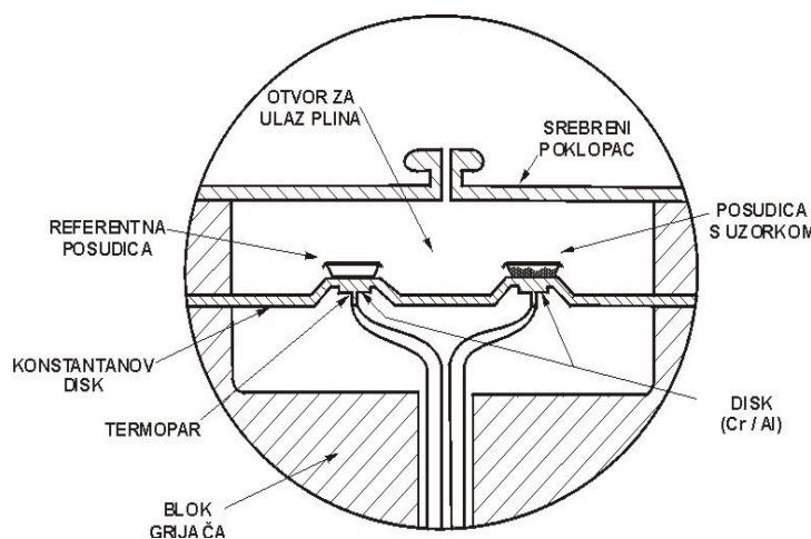
Slika 10. DSC čelija koja radi na principu toplinskog toka [40]
