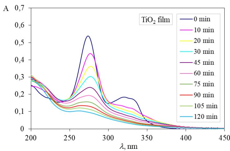
**Slika 28.** UV/VIS spektri fotokatalitičke razgradnje ciprofloxacina (CIP)  $\text{TiO}_2$  filmom, na udaljenosti SOLAR zračenja od fotokatalizatora od 200 mm;  $\gamma_0$  (CIP) = 5 mg/L,  $V$  (CIP) = 100 mL, 25 °C
