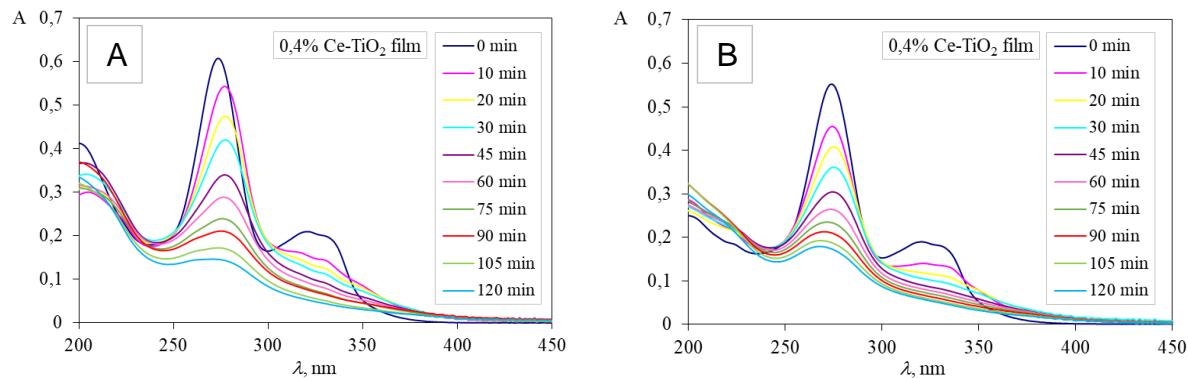
**Slika 26.** UV/VIS spektri fotokatalitičke razgradnje ciprofloksacina (CIP) 0,40% Ce-TiO<sub>2</sub> filmom, na udaljenosti SOLAR zračenja od (A) 200 mm i (B) 300 mm;
