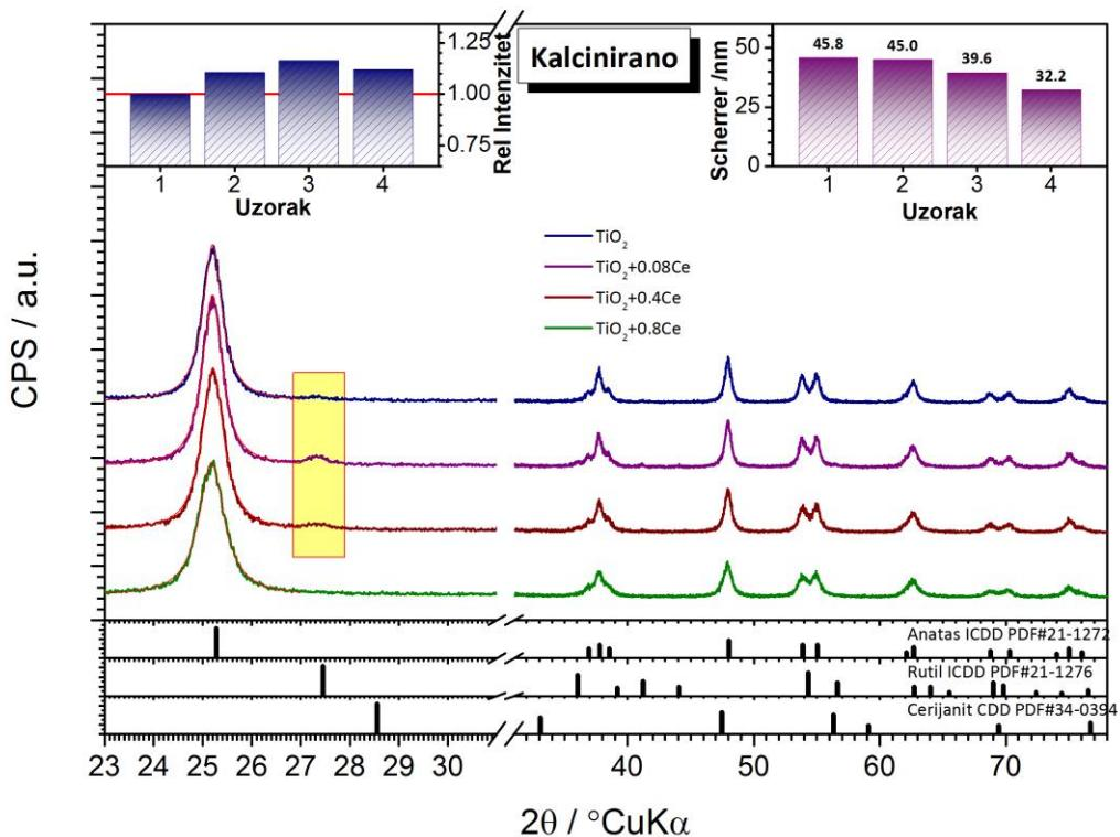
**Slika 18. Difraktogram praškastih uzoraka: TiO<sub>2</sub>, 0,08% Ce-TiO<sub>2</sub>, 0,40% Ce-TiO<sub>2</sub> i 0,80% Ce-TiO<sub>2</sub>**
