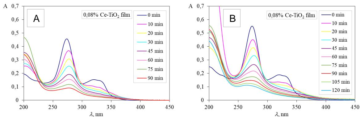
**Slika 25.** UV/VIS spektri fotokatalitičke razgradnje ciprofloksacina (CIP) 0,08% Ce-TiO<sub>2</sub> filmom, na udaljenosti SOLAR zračenja od fotokatalizatora od (A) 200 mm i (B) 300 mm;
