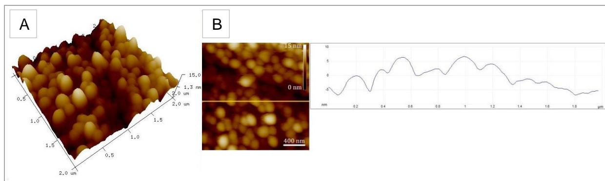
**Slika 22.** (A) 3-D AFM snimka površine ( $2 \times 2 \mu\text{m}$ ) uzorka 0,08% Ce-TiO<sub>2</sub>, (B) 2-D analiza snimke i pripadajuća analiza presjeka pomoću AFM-a
