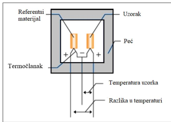
Slika 11. Shematski prikaz uređaja za DTA analizu [42]
