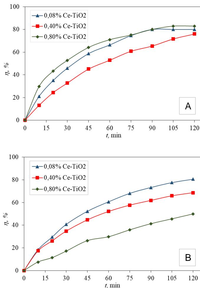
**Slika 32.** Efikasnost uklanjanja ciprofloksacina ( $\gamma_0 = 5 \text{ mg/L}$ ) Ce-TiO<sub>2</sub> filmovima pri temperaturi od  $25^\circ\text{C}$ , na udaljenosti SOLAR zračenja od fotokatalizatora od (A) 200 mm i (B) 300 mm
