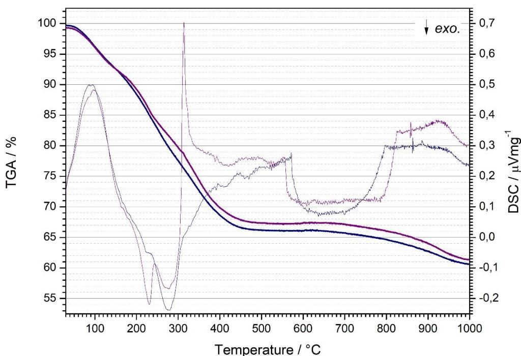
Slika 20. DSC/TG krivulje za uzorke TiO<sub>2</sub> i 0,08% Ce-TiO<sub>2</sub>
