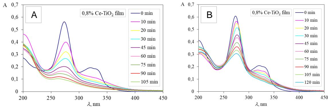
**Slika 27.** UV/VIS spektri fotokatalitičke razgradnje ciprofloksacina (CIP) 0,80% Ce-TiO<sub>2</sub> filmom, na udaljenosti SOLAR zračenja od (A) 200 mm i (B) 300 mm;
