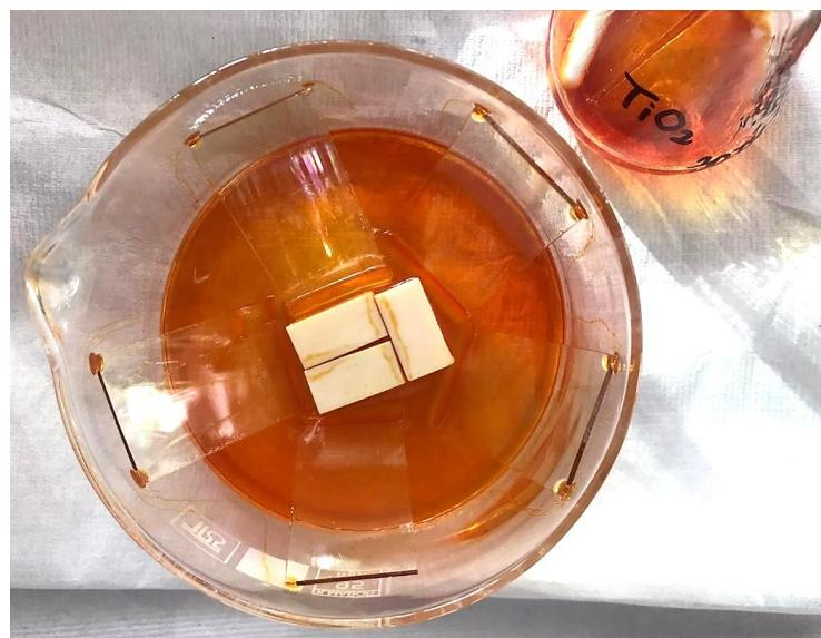
Slika 16. Nanošenje sol-gela na supstrat metodom izljevanja
