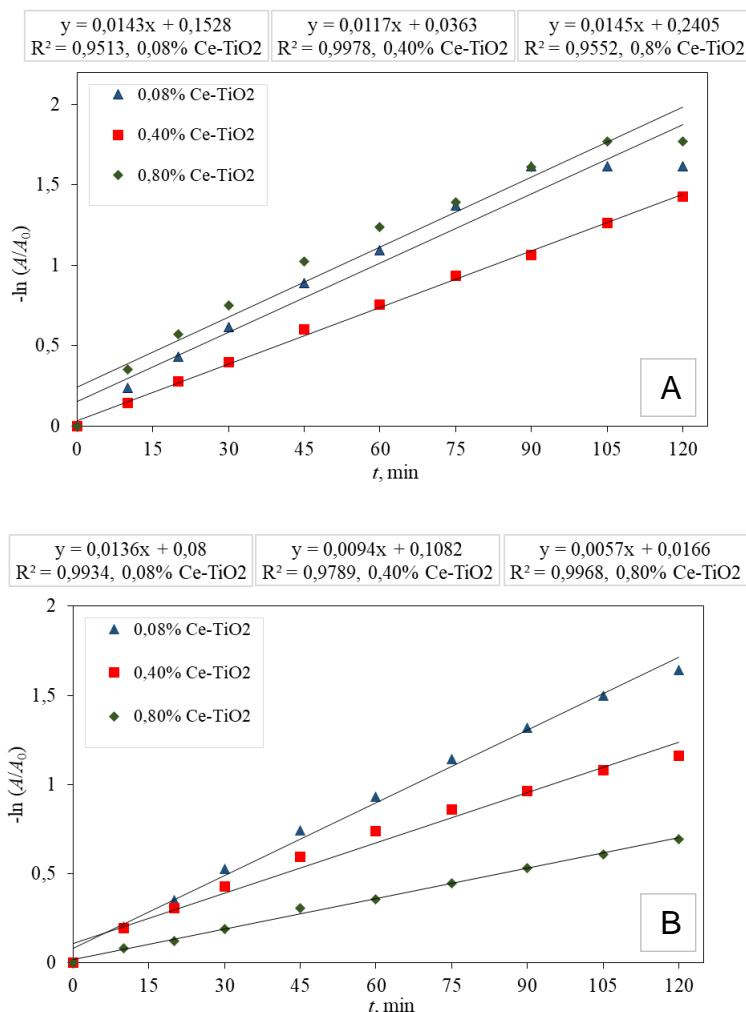
Slika 31. Kinetika fotokatalitičke razgradnje ciprofloksacina ( $\gamma_0 = 5 \text{ mg/L}$ ) Ce-TiO<sub>2</sub> filmovima pri temperaturi od 25 °C, na udaljenosti SOLAR zračenja od fotokatalizatora od (A) 200 mm i (B) 300 mm
