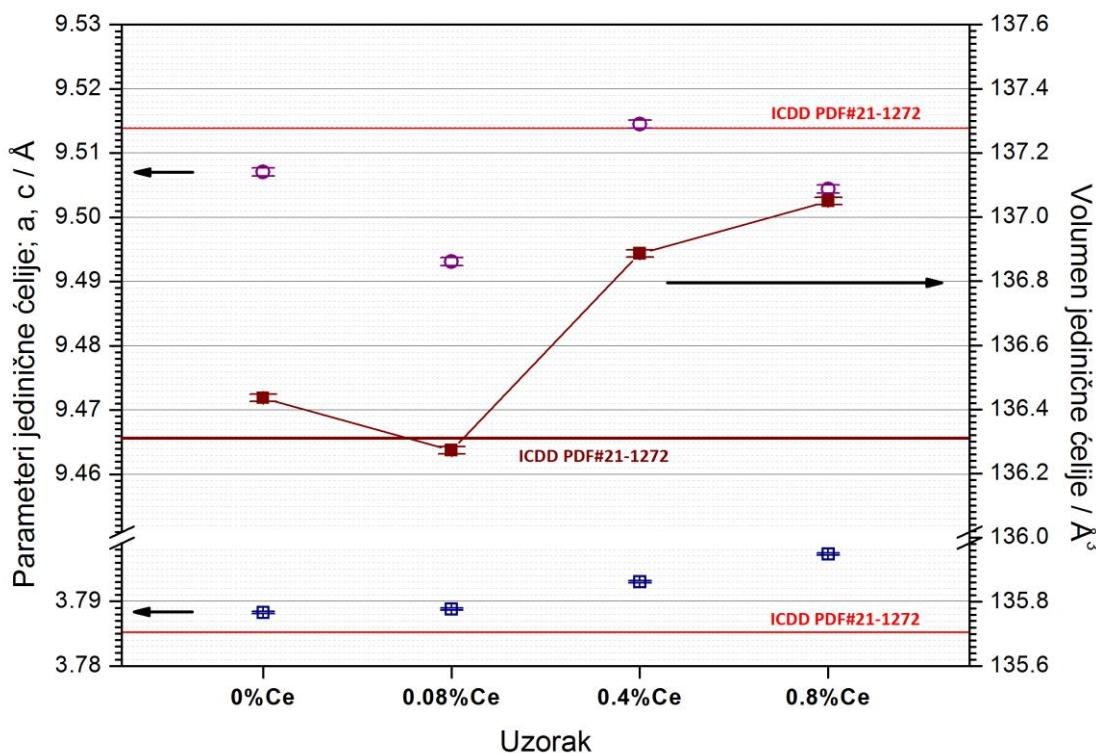
Slika 19. Dijagram parametara i volumena jedinične čelije  $\text{TiO}_2$  te Ce- $\text{TiO}_2$  uzoraka:  $\text{TiO}_2$ , 0,08% Ce- $\text{TiO}_2$ , 0,40% Ce- $\text{TiO}_2$ , 0,80% Ce- $\text{TiO}_2$
