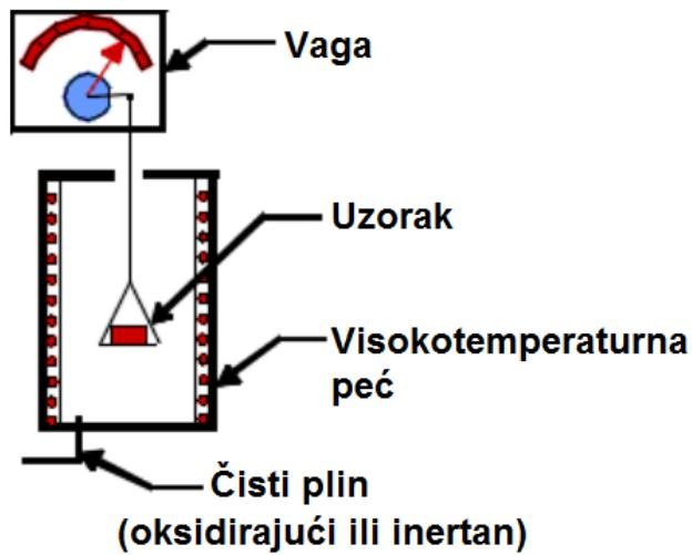
**Slika 9. Shematski prikaz uređaja za TGA [38]**
