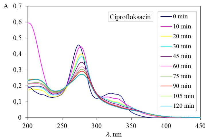
**Slika 29.** UV/VIS spektri fotolitičke razgradnje ciprofloxacina (CIP), na udaljenosti SOLAR zračenja od fotokatalizatora od 200 mm;  $\gamma_0$  (CIP) = 5 mg/L,  $V$  (CIP) = 100 mL, 25 °C
