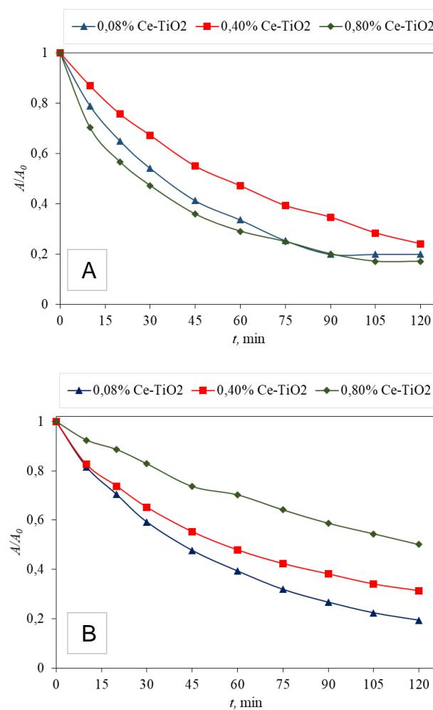
**Slika 30.** Promjena relativne apsorbancije ciprofloksacina ( $\gamma_0 = 5 \text{ mg/L}$ ) tijekom fotokatalitičke razgradnje pri temperaturi od  $25^\circ\text{C}$ , na udaljenosti SOLAR zračenja od fotokatalizatora od (A) 200 mm i (B) 300 mm
