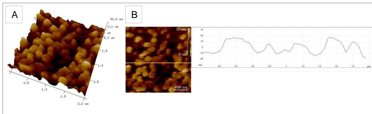
**Slika 23.** (A) 3-D AFM snimka površine ( $2 \times 2 \mu\text{m}$ ) uzorka 0,40% Ce-TiO<sub>2</sub>, (B) 2-D analiza snimke i pripadajuća analiza presjeka pomoću AFM-a
