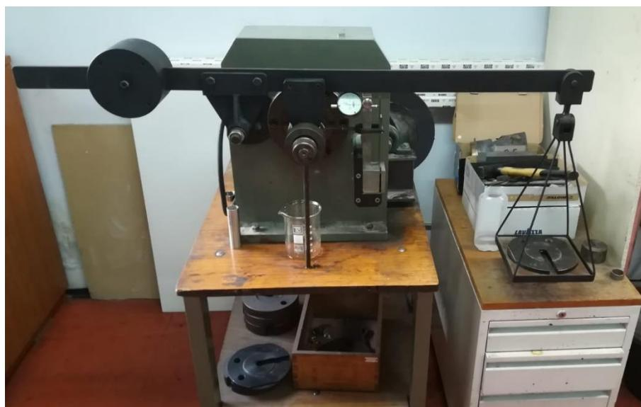
Slika 32. Ispitivanje adhezijskog trošenja "Block on ring" metodom
