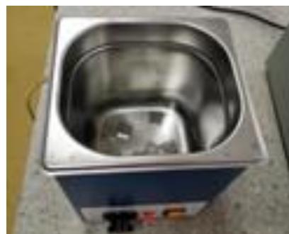
Slika 27. Ultrazvučno čišćenje uzorka
