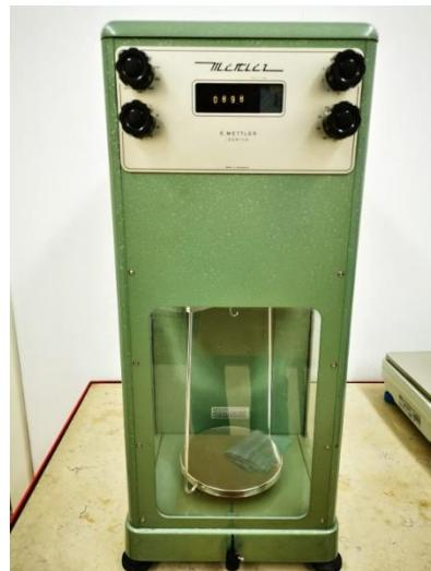
Slika 39. Vaga za mjerenje mase ispitnih uzorka
