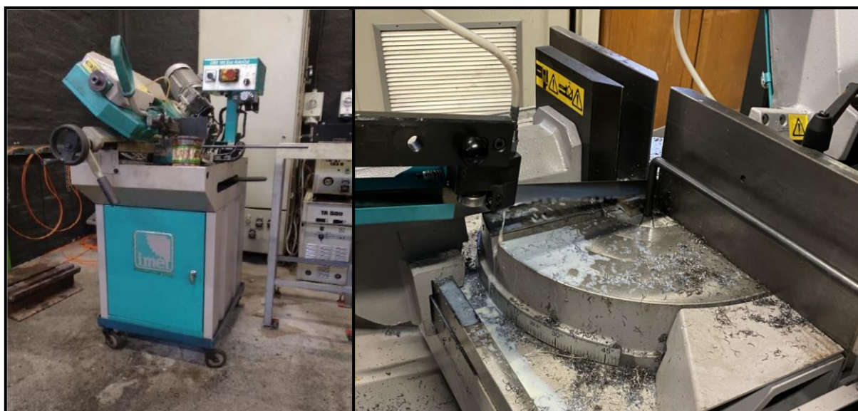
Slika 32. Tračna pila i postupak izrade makrouzoraka
