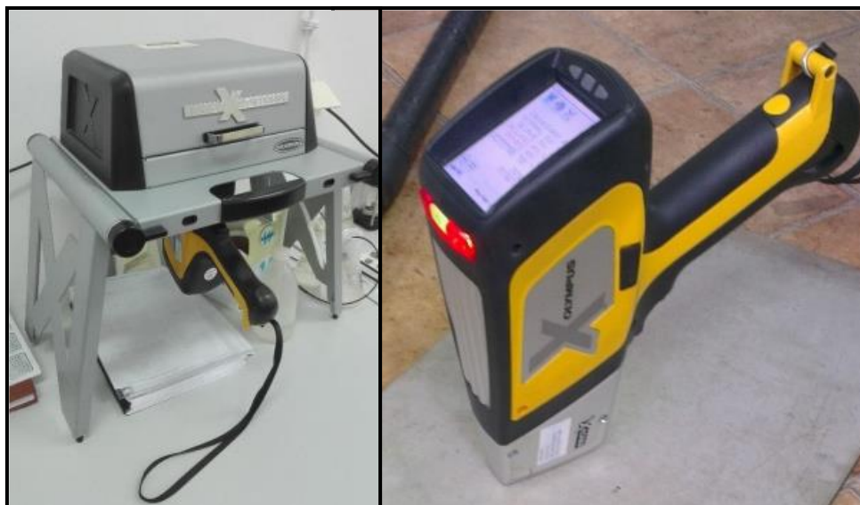
Slika 25. Ispitivanje kemijskog sastava ploče AISI 304 (Olympus XRF Analyzers DELTA Pro)
