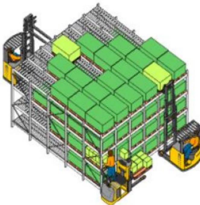
Slika 19. Protočni regal, FIFO sistem [1]
