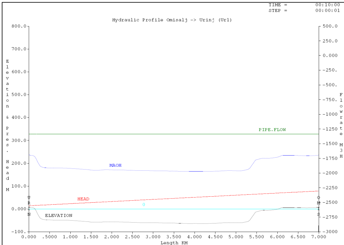
Slika 16. Transfer nafte od Om2 do Ur1 (stabilizacija sustava, vrijeme 10 min)
