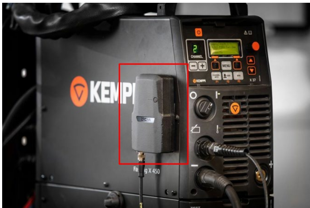
Slika 18 Digitalni uređaj za praćenje rada uređaja za zavarivanje [22]
