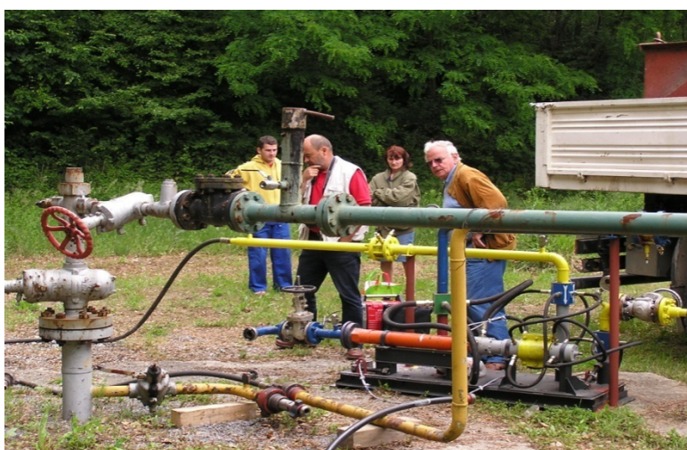
Slika 15 Ispitivanje na površini zemlje s metanom kao radnim fluidom na naftnom polju Šandrovac
