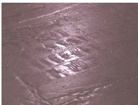
Slika 4-10. Fotografija utiskivanja autogume u ledenu podlogu (tip gume: Mastercraft™ Glacier Grip W195/60 R15 M+S)
