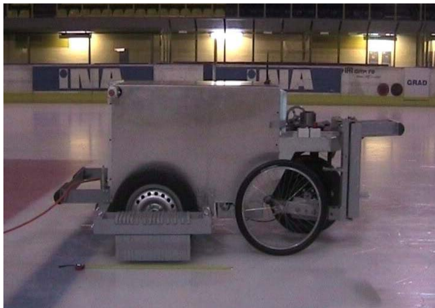
Slika 6-5. Fotografija vozila tijekom eksperimenata emulacije vožnje na usponu prekrivenom ledom.
