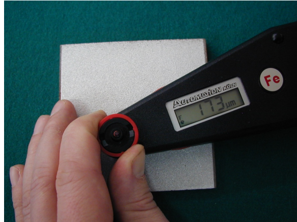
Slika 3.16 Mjerenje debljine sloja.
