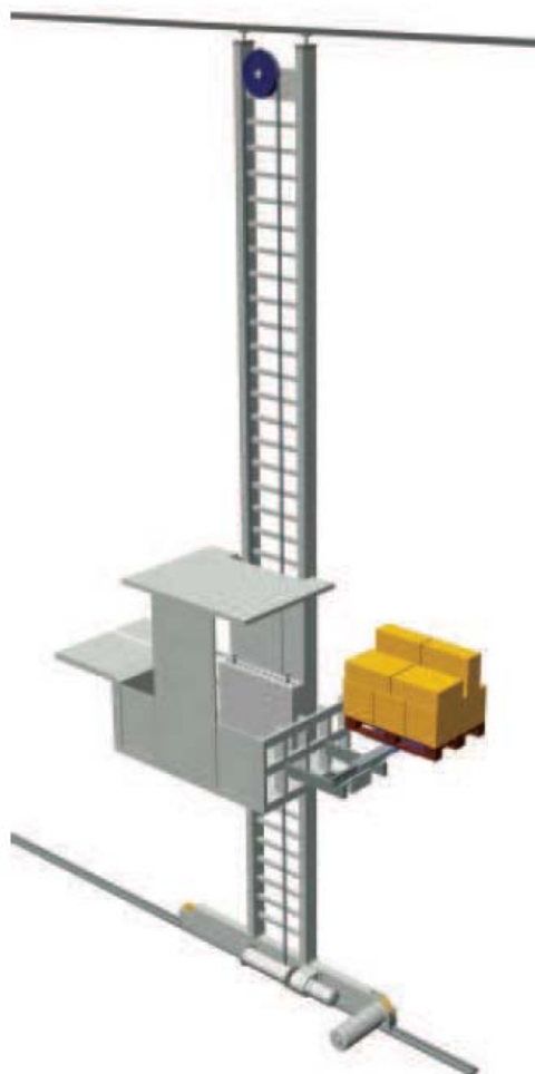
Slika 29. S/R dizalica person-on-board (Viasprint)
