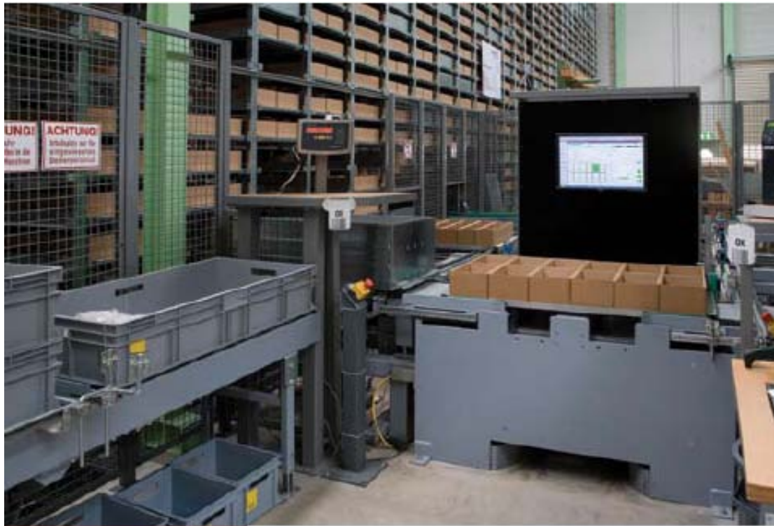
Slika 24. Ulazno/izlazna stanica Mini-load AS/RS
