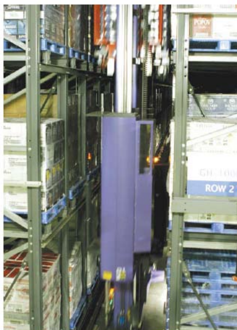
Slika 21. Unit-load S/R dizalica (Daifuku)
