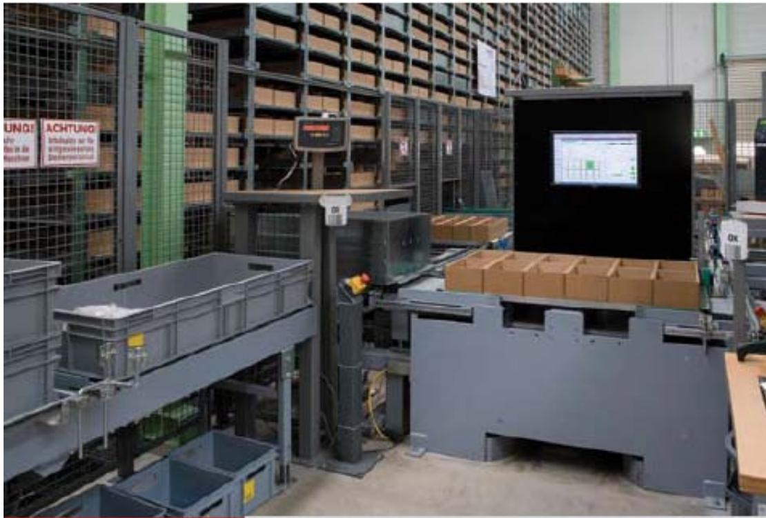
Slika 24. Ulazno/izlazna stanica Mini-load AS/RS
