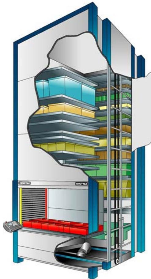
Slika 35. Vertikalni podizni modul (VLM)
