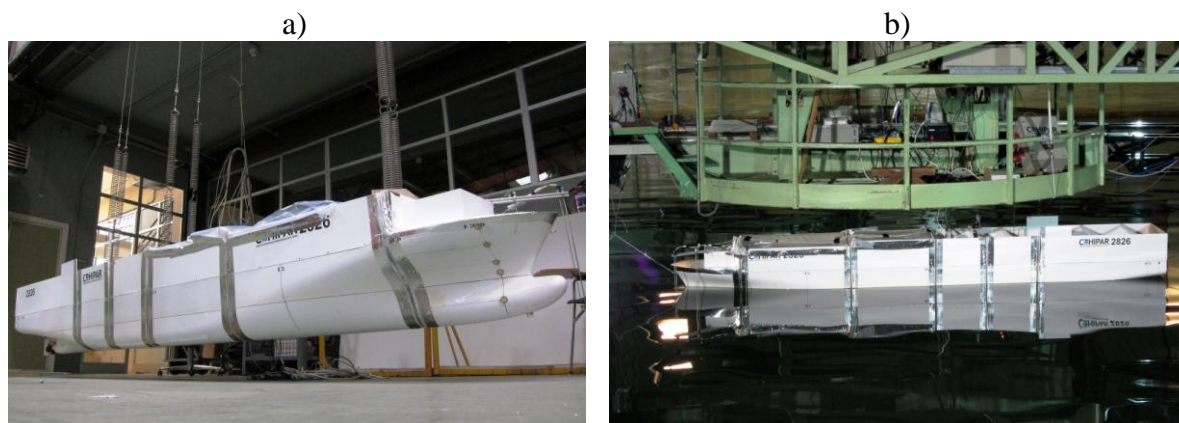
Slika 8.1 Model kontejnerskog broda Rigoletto * ; a) ovješeno, b) tijekom ispitivanja u vodi
