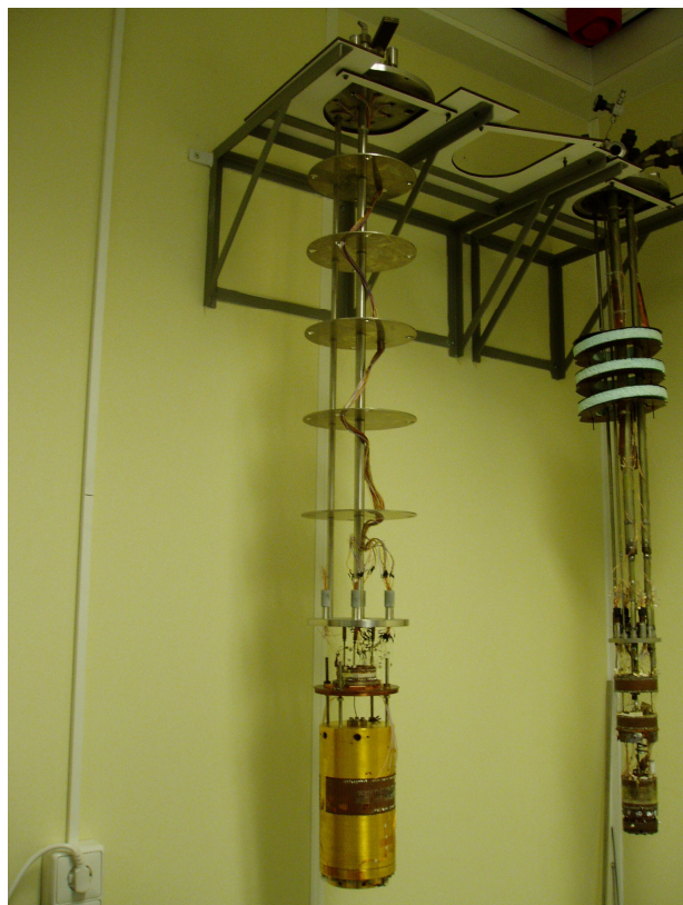
Slika 21 Plinski termometar za realizaciju temperaturne ljestvice u području 3 K do 24.5 K u institutu NMI, Delft, Nizozemska izvađen iz termostatirane posude. Termometar je tijekom mjerenja montiran u spremniku s tekućim helijem, a umjerava se u tri temperaturne točke, [38].
