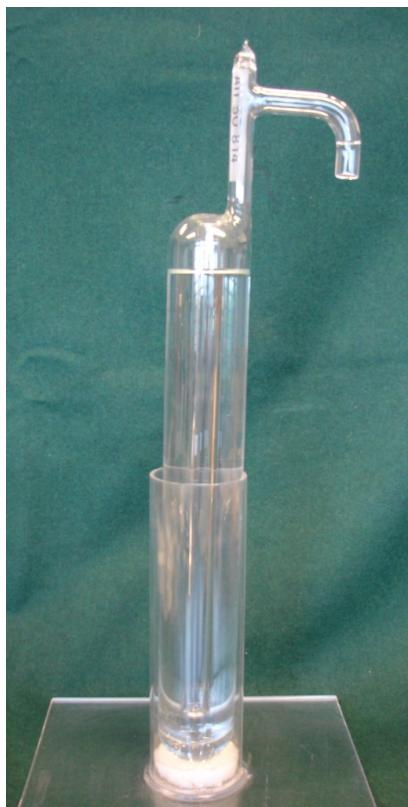
Slika 30 Trojna točka vode Isotech model E11
