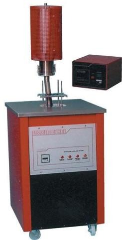
**Slika 46 Termometrijske peći ra realizaciju fazne promjene u otvorenim fiksnim točkama.**
