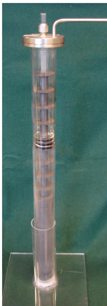
Slika 32 Fotografija otvorenog tipa fiksne točke koji se koristi u LPM-u
