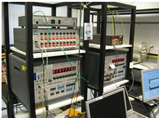
Slika 38 Otporni mjerni mostovi ASL F18
