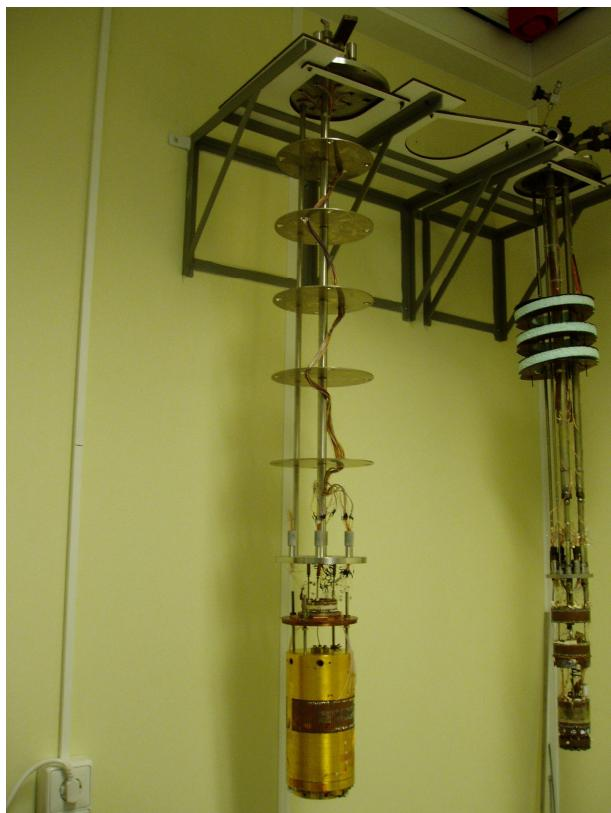
Slika 21 Plinski termometar za realizaciju temperaturne ljestvice u području 3 K do 24.5 K u institutu NMI, Delft, Nizozemska izvađen iz termostatirane posude. Termometar je tijekom mjerjenja montiran u spremniku s tekućim helijem, a umjerava se u tri temperaturne točke, [38].
