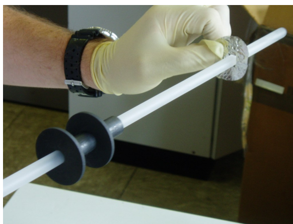
b) Unutrašnja kvarcna cijev, grafitni prsteni i platinski listići
