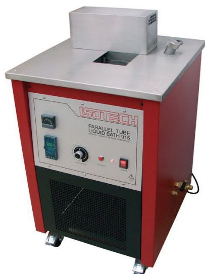
a) Slika 44 Temperaturna kućišta zapostizanje i održavanje trojne točku žive, trojne točke vode i tališta galija
