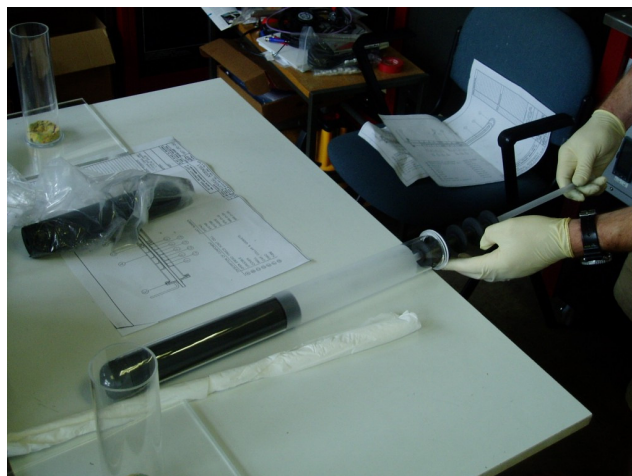
c) Ulaganje kvarcne cijevi u grafitnu kokilu
